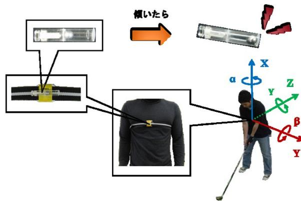
図7 器具とセンサの取り付けと軸の定義
