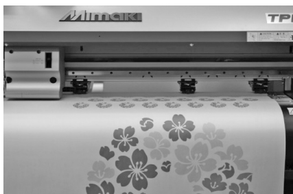
昇華転写インク搭載のデジタル・ファブリック・プリンタによるデータの出力
