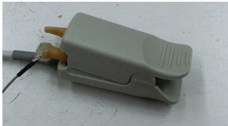
Fig.4 圧力脈波計と光電式脈波計を一体化した脈波計
