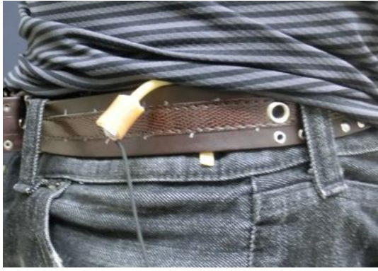
Fig.17 チューブ型圧力脈波計の腰での計測方法 (左写真)
