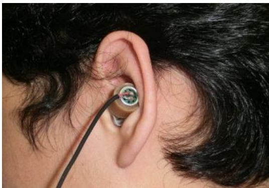
Fig.15 イヤホン型圧力脈波計の計測方法（左写真）
