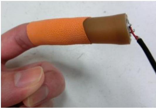
Fig.13 指尖圧力脈波計の計測方法
