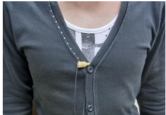
Fig.15 イヤホン型圧力脈波計の計測方法（左写真）
