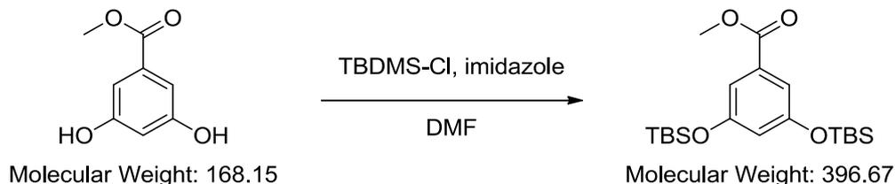
窒素雰囲気下 100 mL 二口ナス型フラスコに **3,5-OH COOMe** 7.52 g (44.7 mmol)、imidazole 9.13 g (134.1 mmol)を秤とり DMF 20 mL に溶解させた。DMF 30 mL に溶解させた TBDMSCl 16.17 g (107.3 mmol)を徐々に加え、室温で 12 時間攪拌、TLC で反応の完結を確認後、飽和重曹水を加え反応を停止させた。hexane で 3 回抽出後、食塩水で洗浄、無水硫酸マグネシウムで乾燥した。溶媒を減圧留去した後、ポンプアップを行った。
