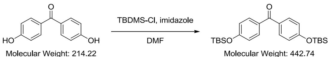
窒素雰囲気下 50 mL ニロナス型フラスコに imidazole 2.04 g (30.0 mmol)、*tert*-butyldimethylchlorosilane (TBDMSCl) 3.77 g (25.0 mmol)、4,4'-dihydroxybenzophenone 2.14 g (10.0 mmol)を秤とり DMF 15 mL に溶解させた。40 °Cで 5 時間攪拌、TLC で反応の完結を確認後、精製水を加え反応を停止させた。hexane で 3 回抽出後、精製水で洗浄、無水硫酸マグネシウムで乾燥した。溶媒を減圧留去した後、カラムクロマトグラフィー(TLC / sol. hexane, Rf value : 0.10)で精製後、ポンプアップを行った。
