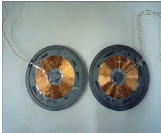
図2 スープ皿型フェライトコアを用いた一次・二次コア分離型単相変圧器
