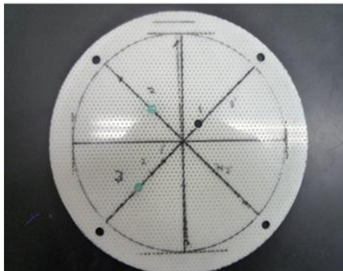
図 4.1.9 穴あけ加工後グリル（板厚 2mm、開口率 10%）
