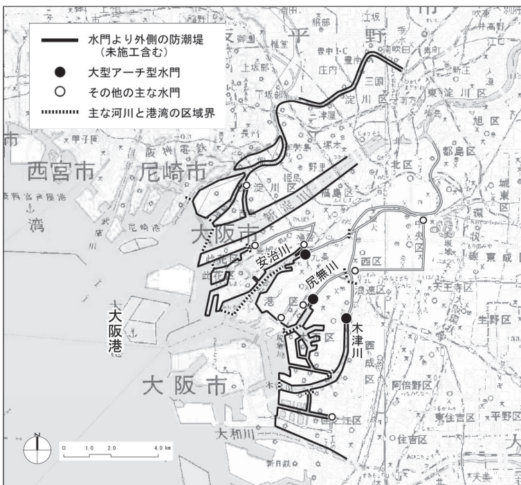
図 1-14 大阪における高潮対策の概況 —水門方式— (大型防潮水門下流の防潮堤 (外郭堤防)、主要な水門のみ記載)
