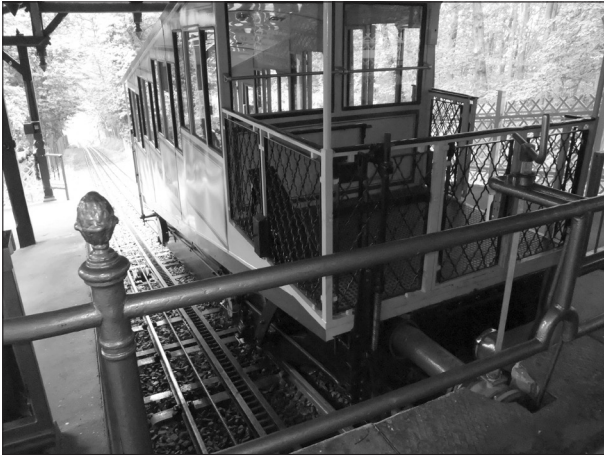
図-2 ヴィースバーデンの水力ケーブルカー
