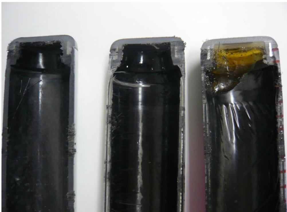
図 4-3 バットヘッド部の内部構造
