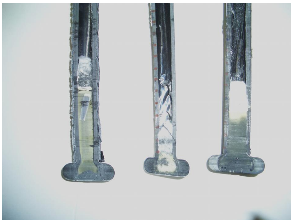
図 4-4 バットグリップ部の内部構造
