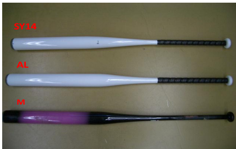
図 1.FRP 製ソフトボール用バット
