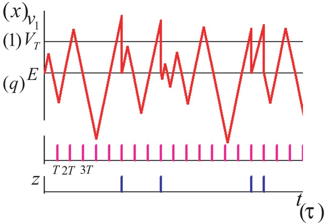
図 3.13: 2 種類のスイッチを持つ PWC-CSO の時間波形
