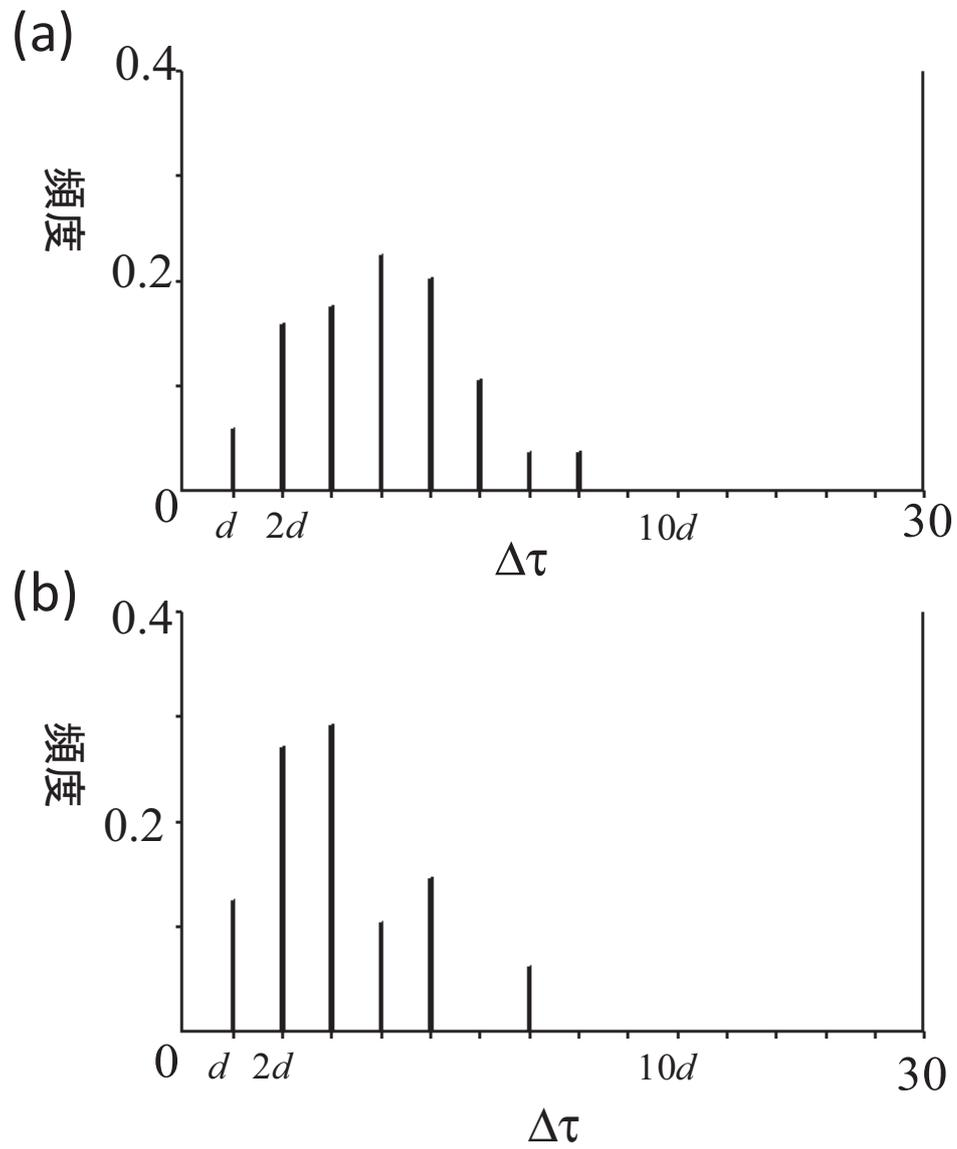
図 3.16: 2 種類のスイッチを有する PWC-CSO の ISI のヒストグラム例 (a)  $q = 0.1$  (b)  $q = 0.5$
