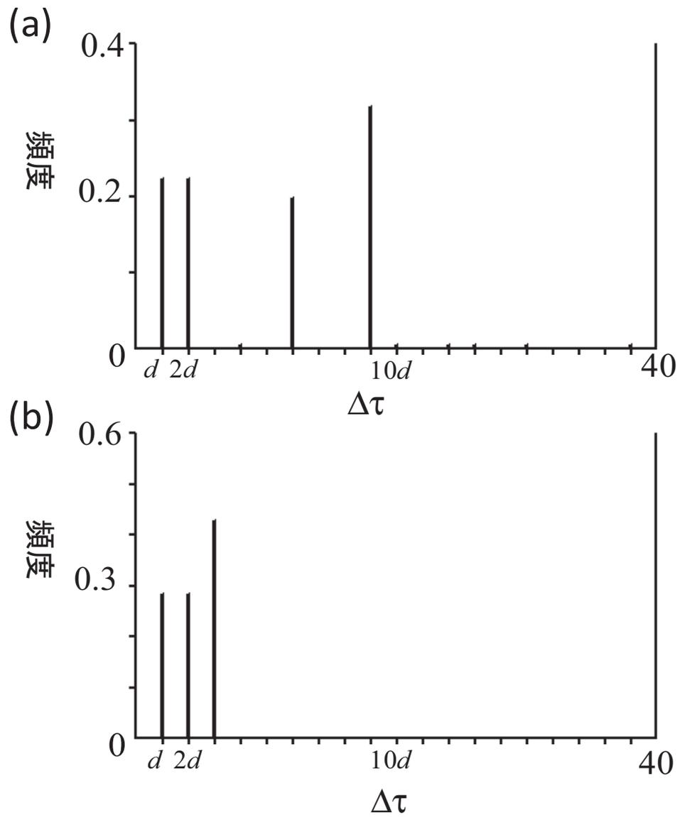
図 3.6: 2種類のスィッチを有する PWC-CSO の ISI のヒストグラム例 (a)  $q = 0.1$  (b)  $q = 0.5$
