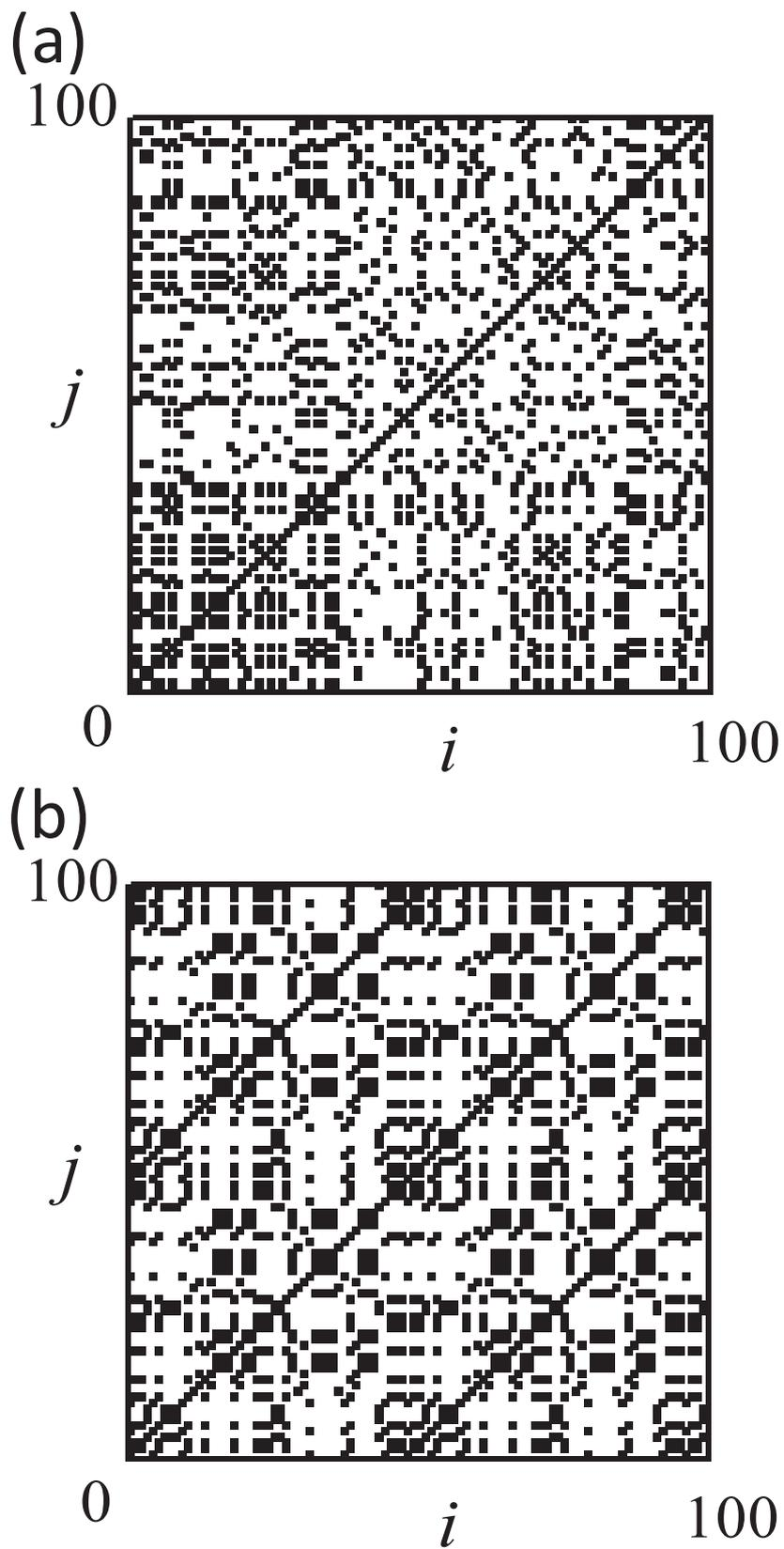
図 3.18: 2 種類のスィッチを有する PWC-CSO の ISI から作成した RP (a)  $q = 0.1$  (b)  $q = 0.5$
