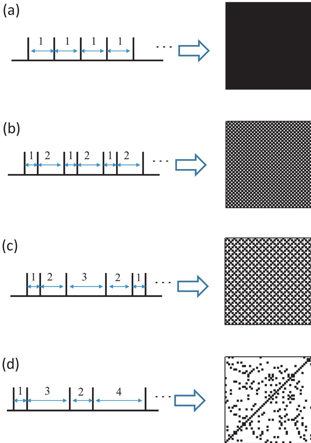
図 2.10: リカレンスプロットの作成例 (a) 一定間隔のスパイク列 (b) 2 周期のスパイク列 (c) 3 周期のスパイク列 (d) ランダムな間隔のスパイク列
