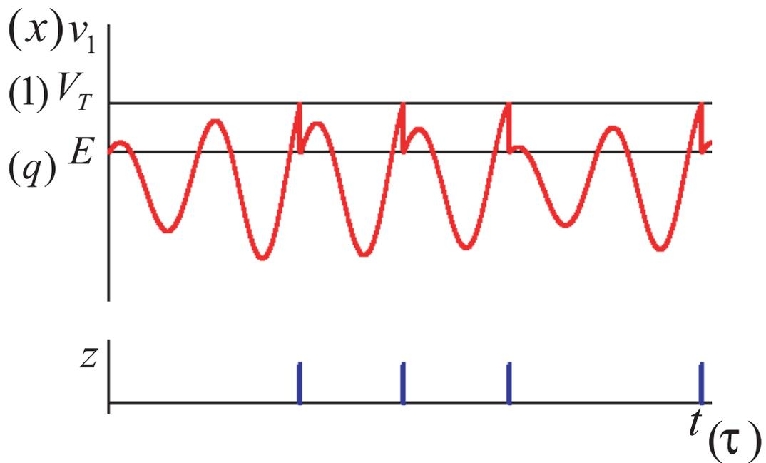
図 2.2: 区分散形カオスのスパイク発振器の時間波形
