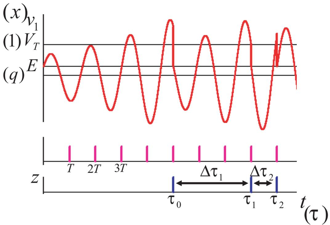
図 3.3: 2種類のスィッチを持つCSOの時間波形
