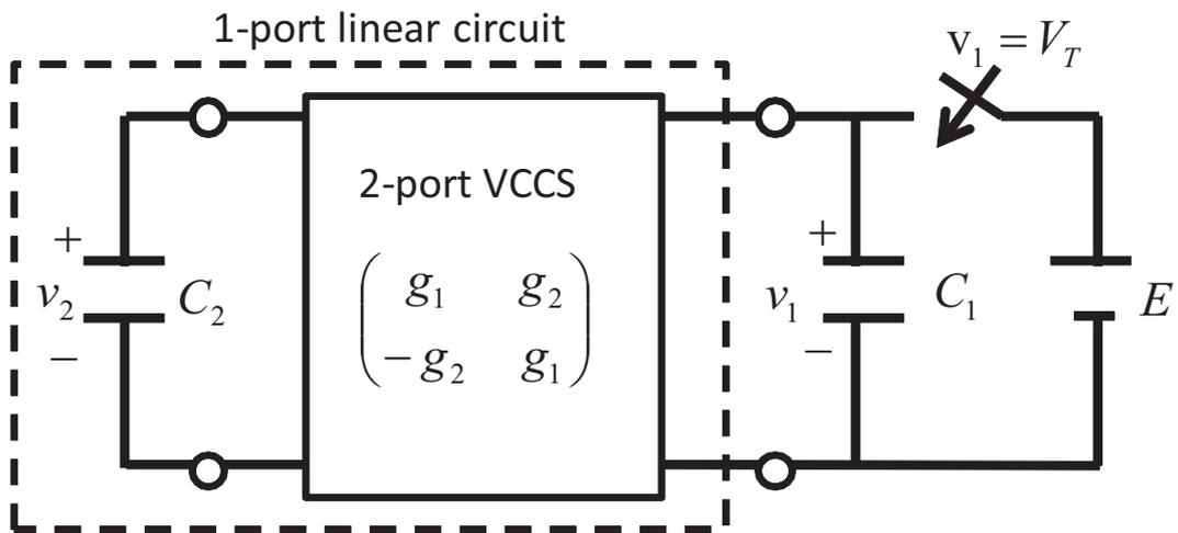
図 2.1: 区分散形カオスのスパイク発振器
