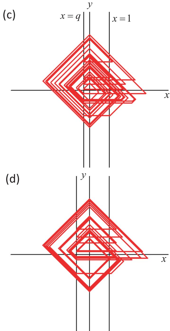
図 3.15: 2 種類のスイッチを持つ PWC-CSO の軌道例 ( $a = 2, d = 2$  (c)  $q = -0.3$  (d)  $q = -0.65$ )
