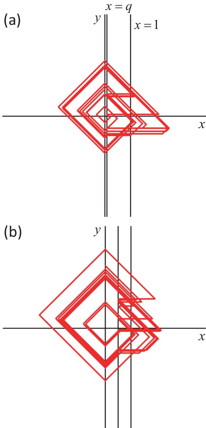
図 3.14: 2 種類のスイッチを持つ PWC-CSO の軌道例 ( $a = 0.2$ ,  $d = 2$  (a)  $q = 0.1$  (b)  $q = 0.5$ )
