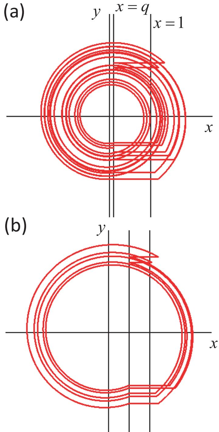
図 3.4: 2 種類のスイッチを持つ CSO の軌道例 ( $\delta = 0.05$ ,  $d = 2$  (a)  $q = 0.1$  (b)  $q=0.5$ )
