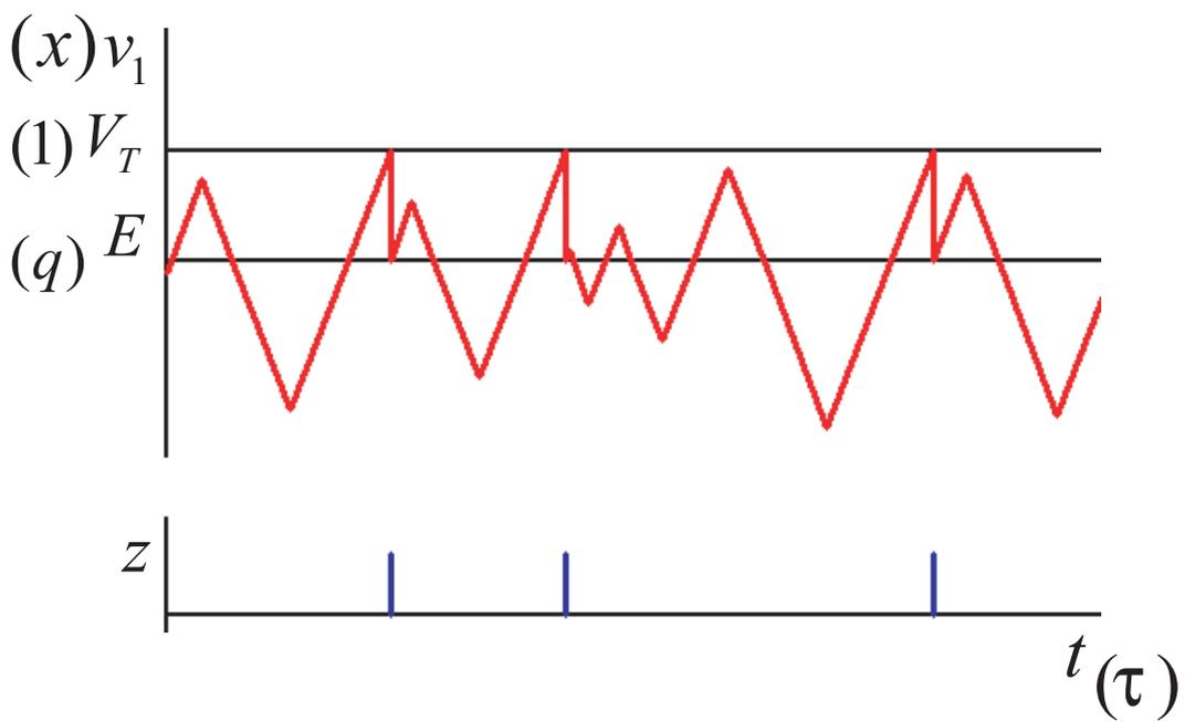
図 2.7: 区分定数カオス的スパイク発振器の時間波形
