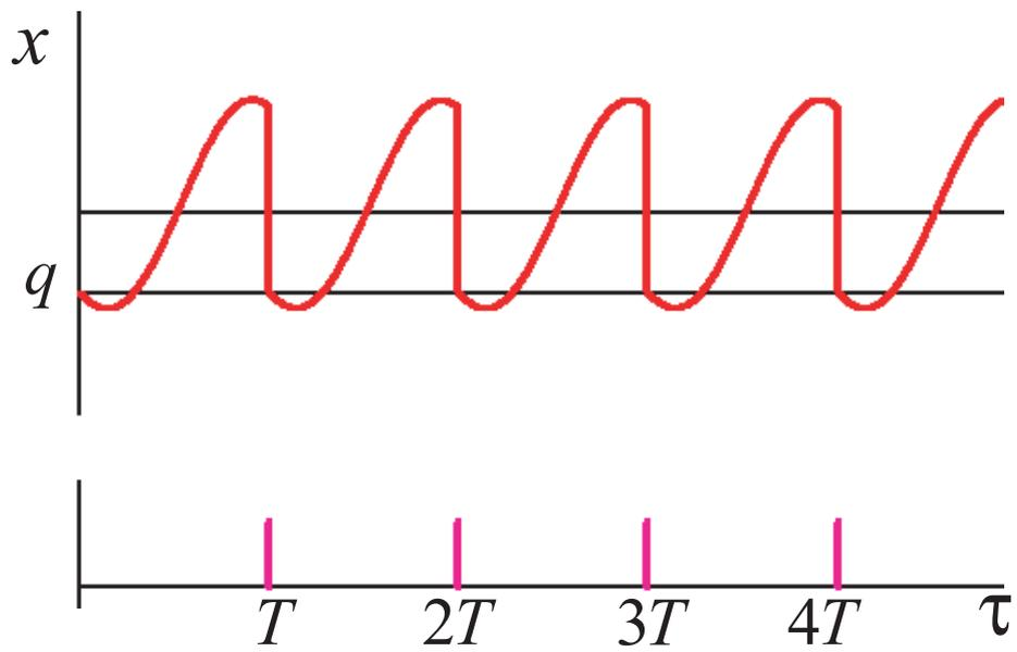
図 3.1: 時間にのみ依存するスイッチングルールを用いたときの CSO の時間波形
