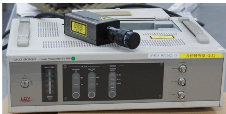
図 6.1 レーザードップラー振動計
