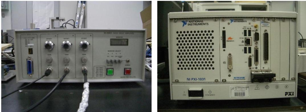
図 4.8 PXI およびアンプ
