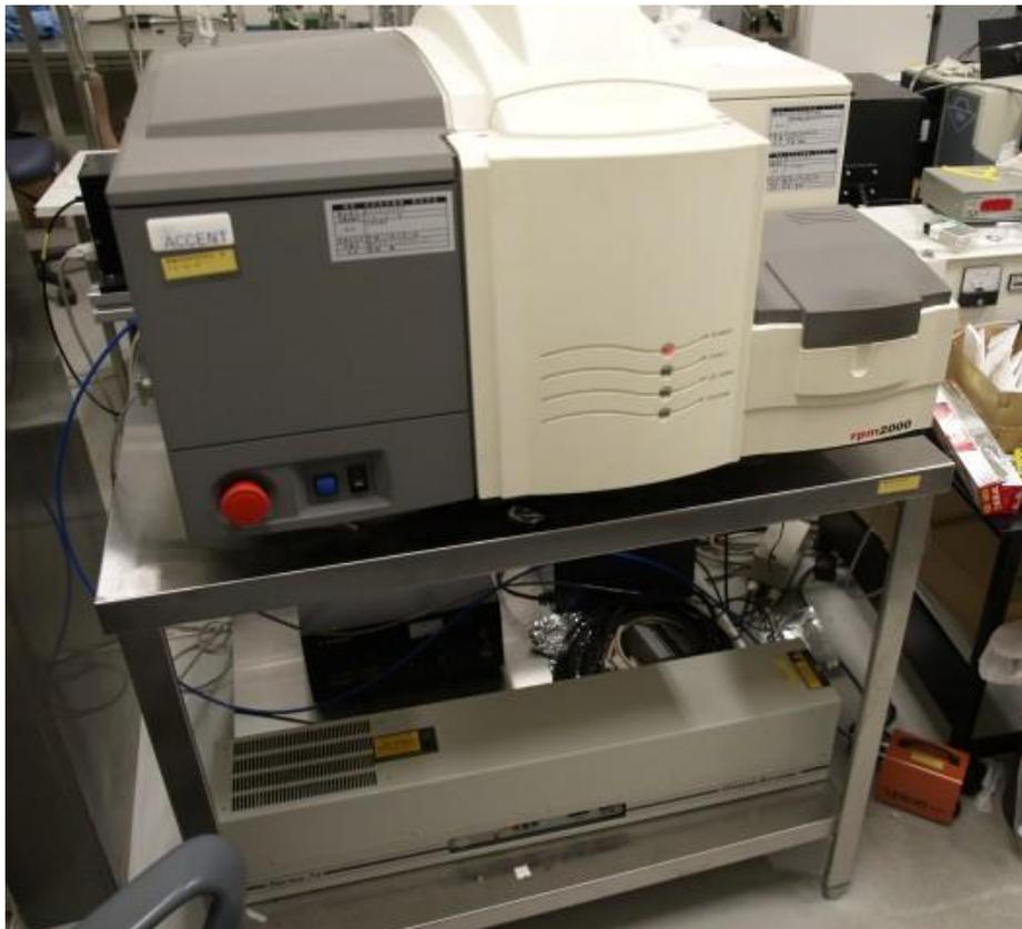
図 14 室温フォトルミネッセンス(PL)測定装置の外観
