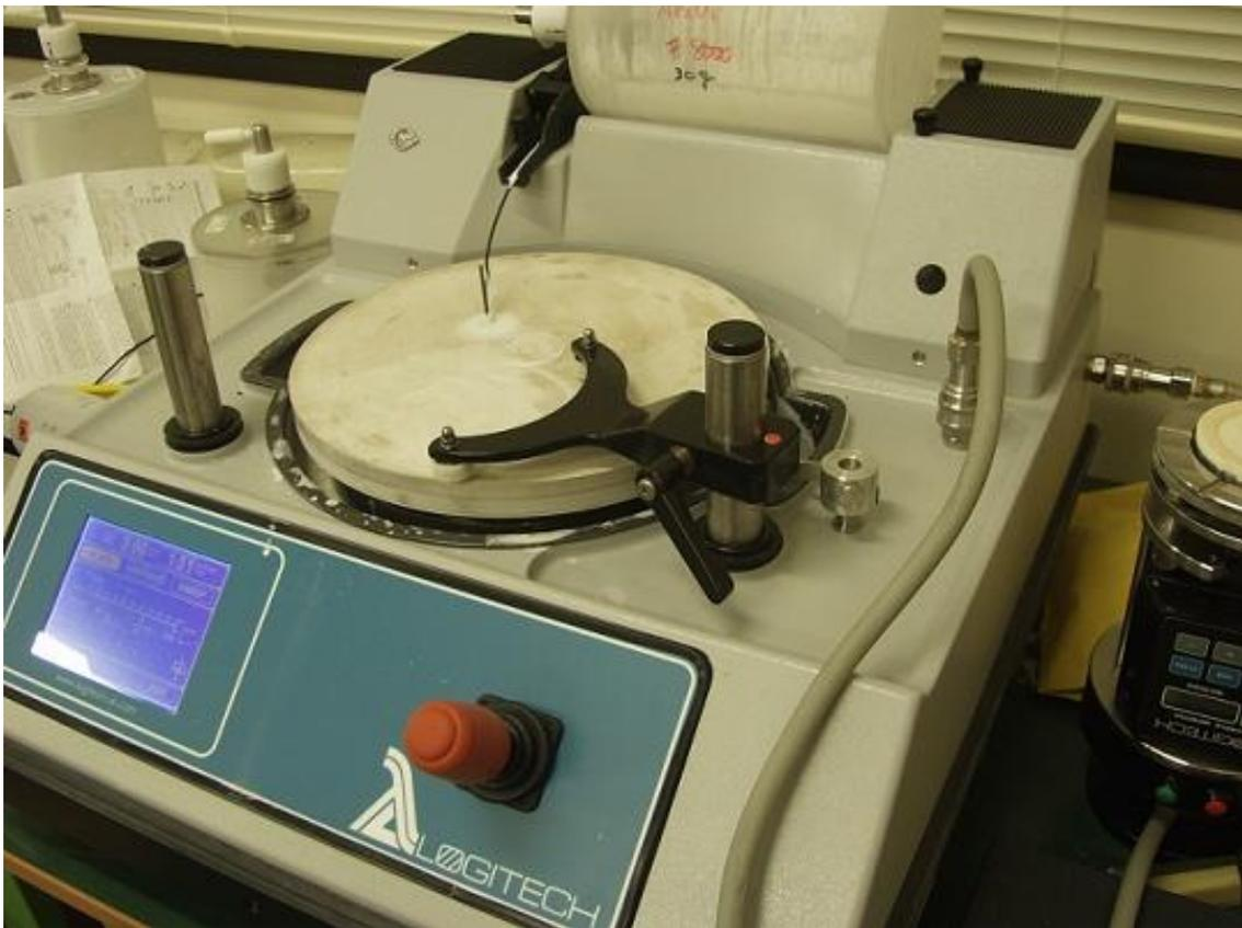
図6 本実験に使用した片面研磨装置
