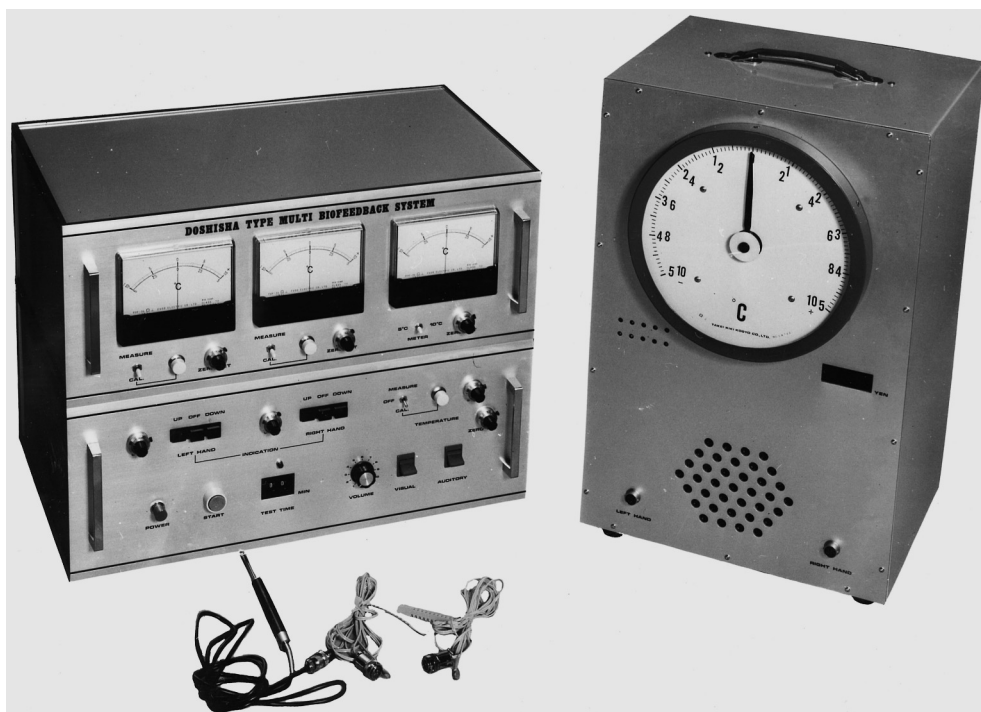
図3 同志社型マルチバイオフィードバックシステム＝皮膚温度測定装置
