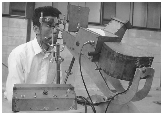
図2b 写真資料の「甲南式アイカメラ」
