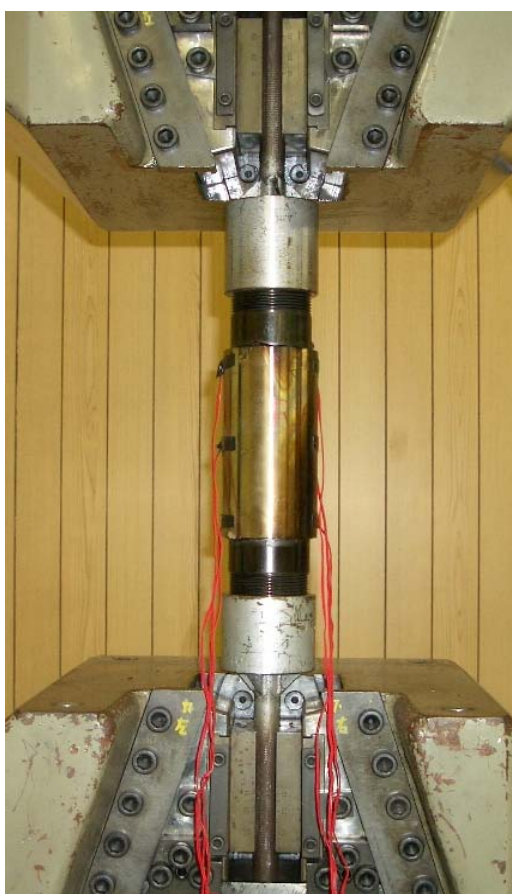
図 4.9 継手強度試験の様子
