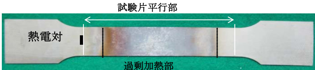
図 3.6 形状回復応力測定試験後の試験片
