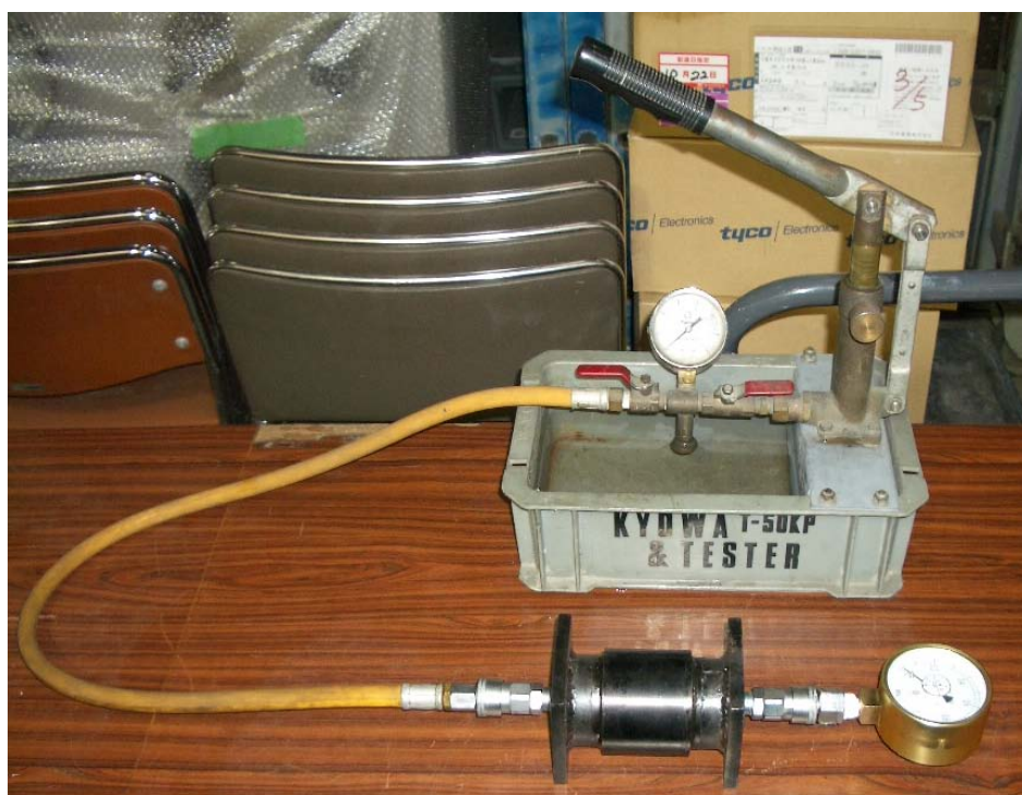
図 4.11 耐水圧試験の様子
