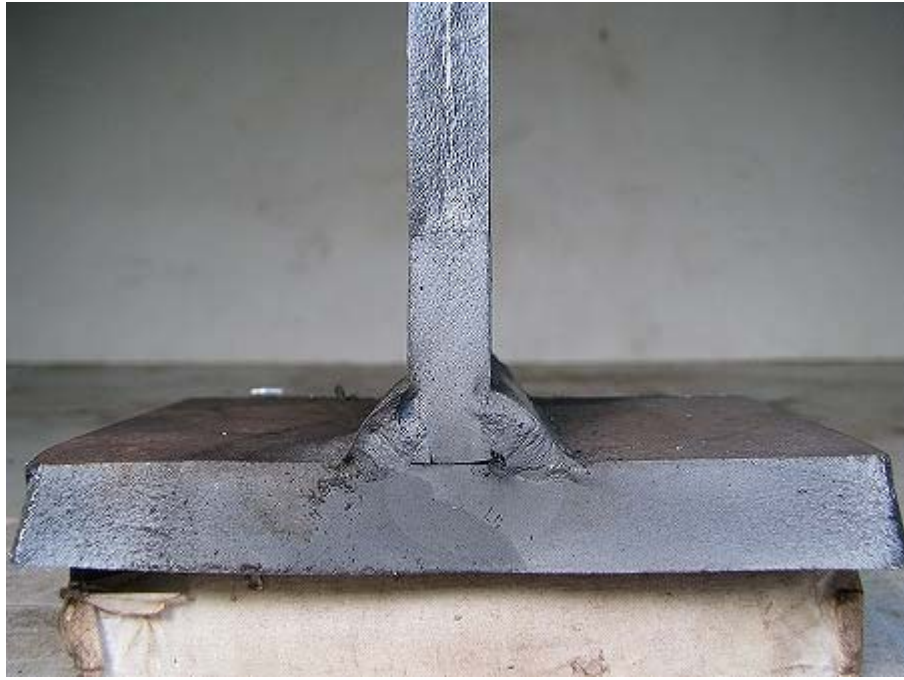
写真-2.181 B-1 試験体 疲労破面-北側
