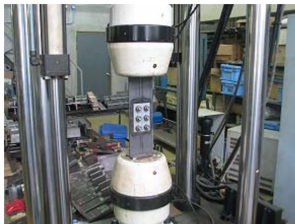
写真-3.5 AP 試験体の試験状況
