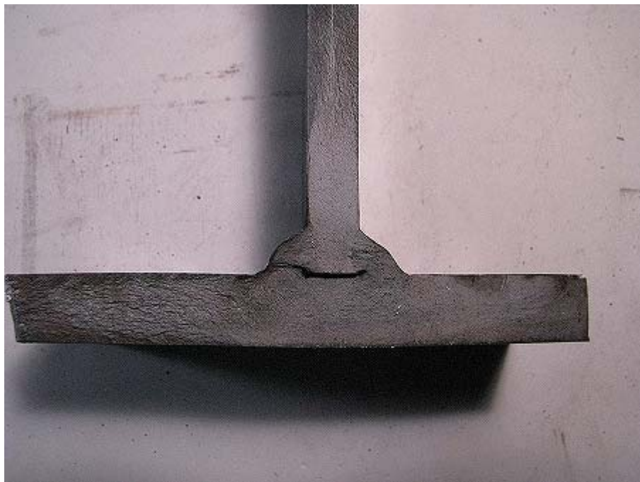
写真-2.180 A-1 試験体 疲労破面-南側
