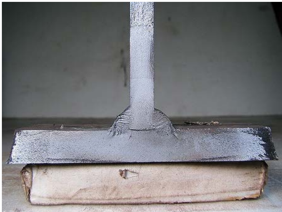
写真-2.188 C-2 試験体 疲労破面-南側
