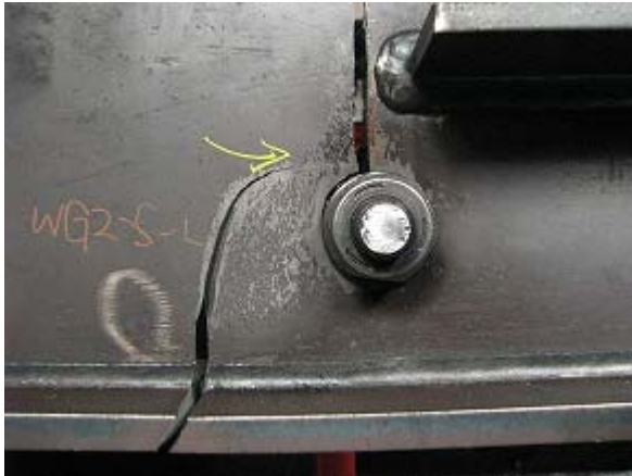
写真-2.67 B-1 試験体下フランジ破断状況
