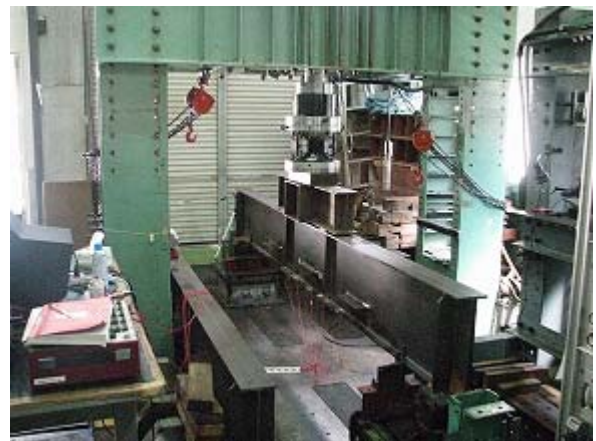
写真-2.10 桁試験体の疲労試験状況
