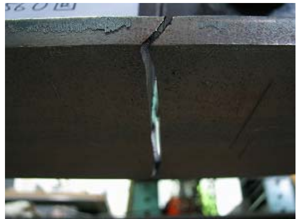
写真-2.94 C-1 試験体下フランジ破断状況
