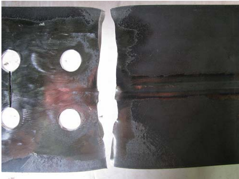
(a) 破断状況
