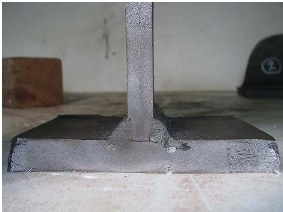
写真-2.184 B-2 試験体 疲労破面-南側
