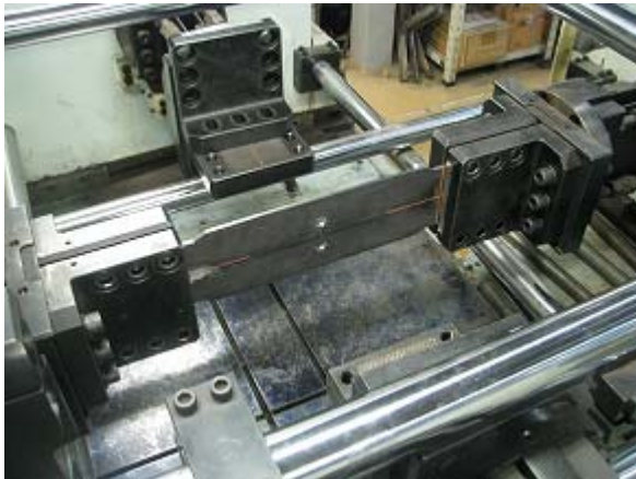
写真-3.3 SH 試験体の試験状況
