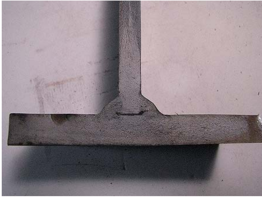
写真-2.179 A-1 試験体 疲労破面-北側
