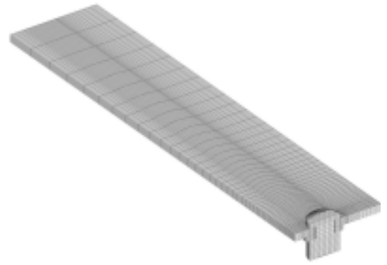
図-4.19 BSH 試験体モデル(1/4モデル)
