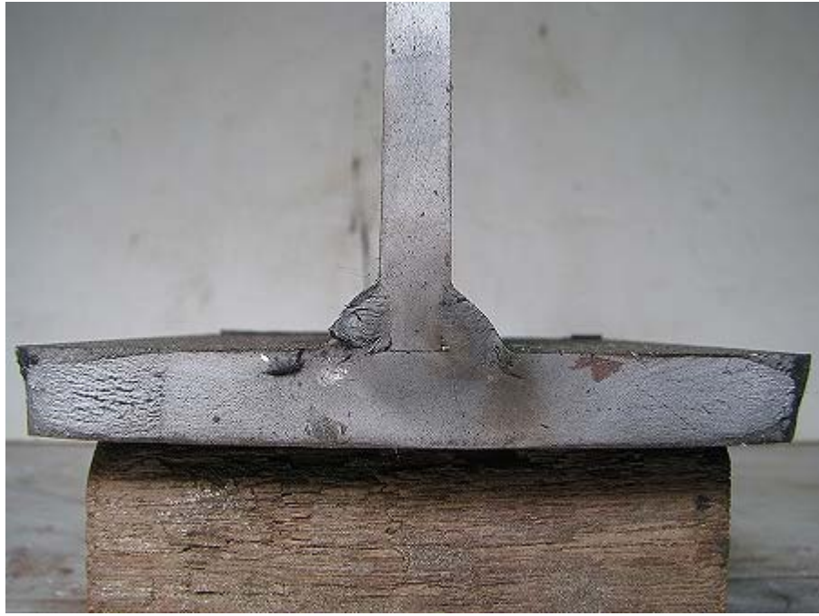
写真-2.183 B-2 試験体 疲労破面-北側
