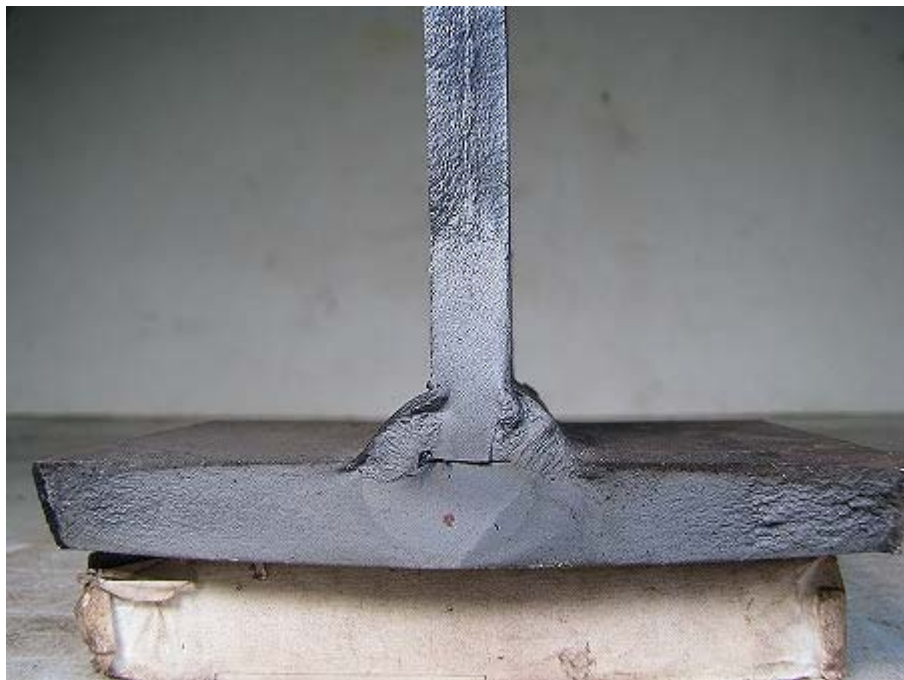
写真-2.182 B-1 試験体 疲労破面-南側
