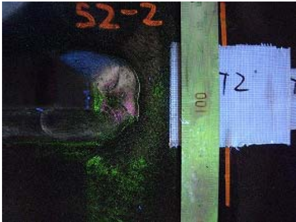
写真-2.21 WG2-S 初期き裂 (西面)
