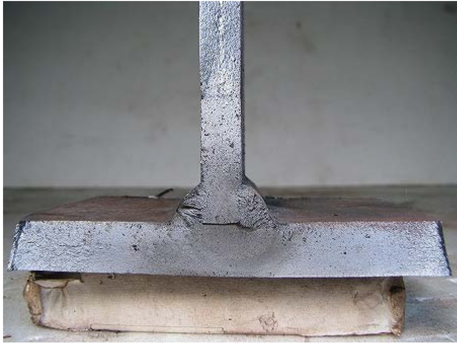
写真-2.185 C-1 試験体 疲労破面-北側
