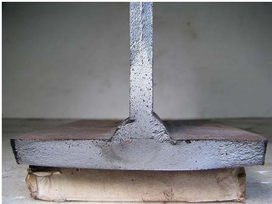
写真-2.186 C-1 試験体 疲労破面-南側
