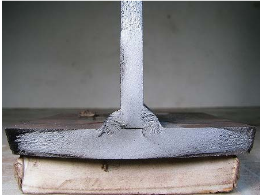
写真-2.187 C-2 試験体 疲労破面-北側
