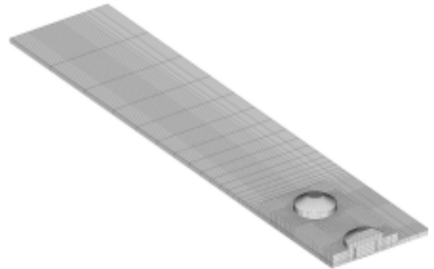
図-4.6 AP 試験体 (トルシアボルトモデル)
