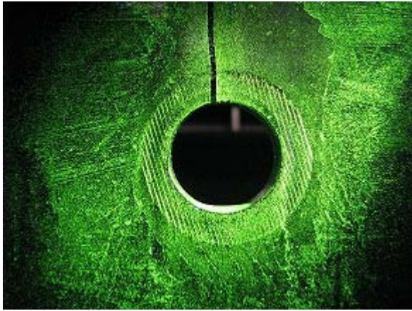
写真-2.55 WG1-N 疲労試験終了後
