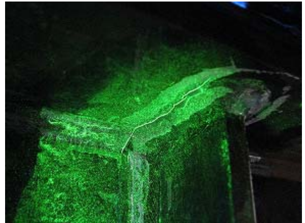
写真-2.160 載荷点 南側東面き裂状況(1)
