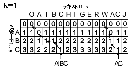
図 2.3: 動的計画法による編集距離計算 (テキストが長い場合)
