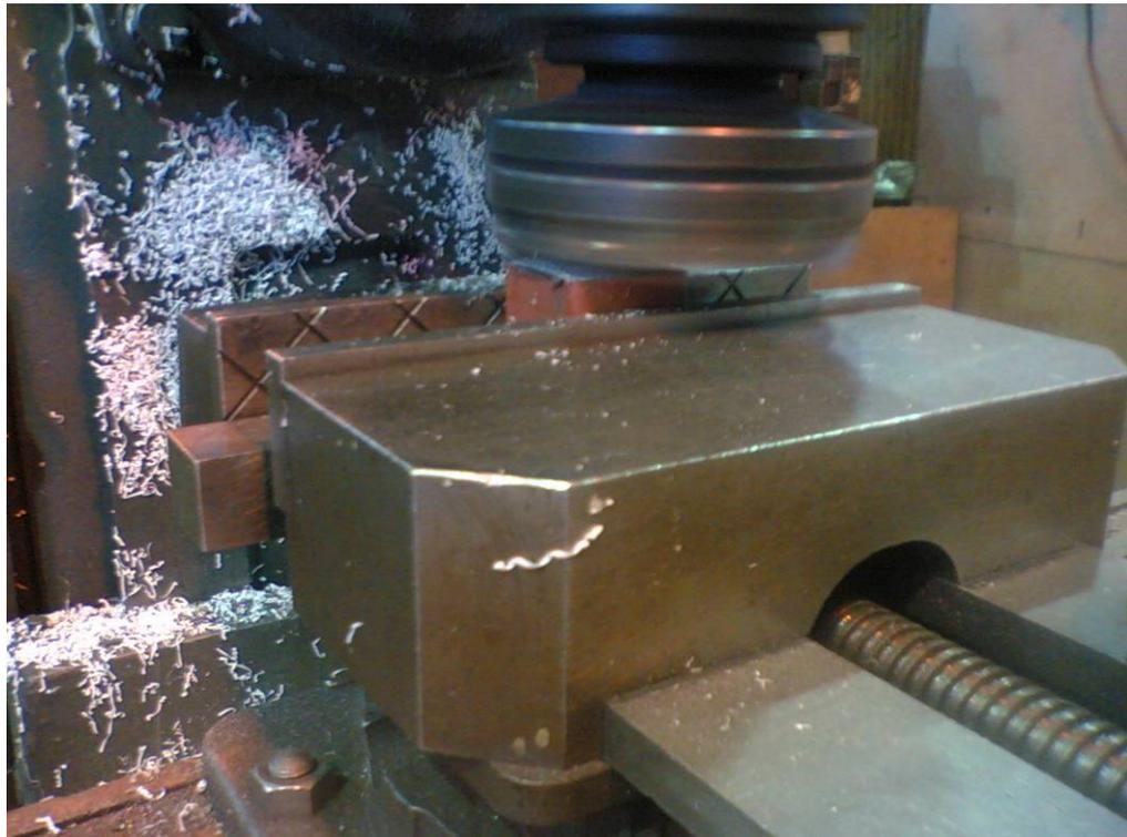
写真 2.2 アンダーカット切削状況
