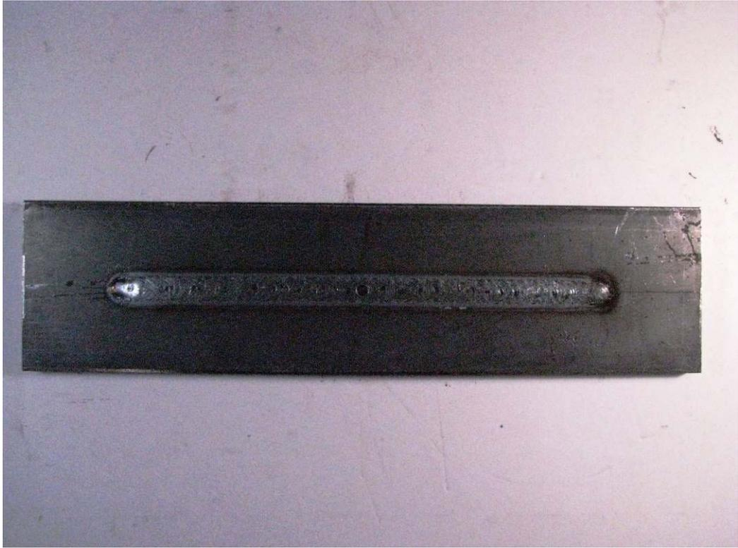
(a)板厚加工前 (  $t=12\text{mm}$  )
