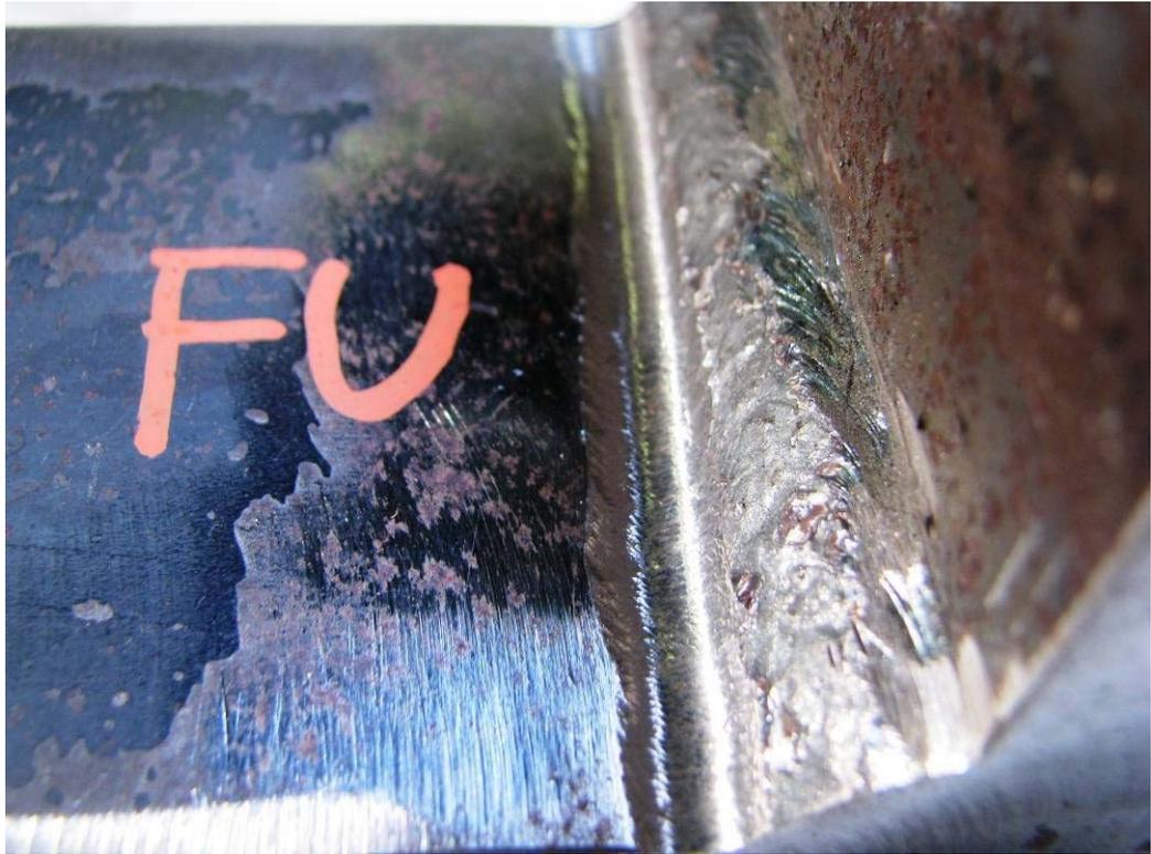
写真 5.1 溶接止端の外観
