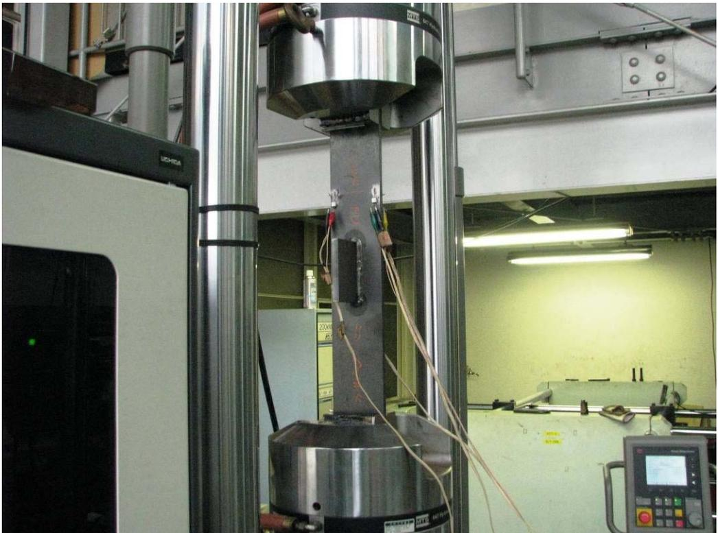
写真 4.5 面外ガセットの疲労試験
