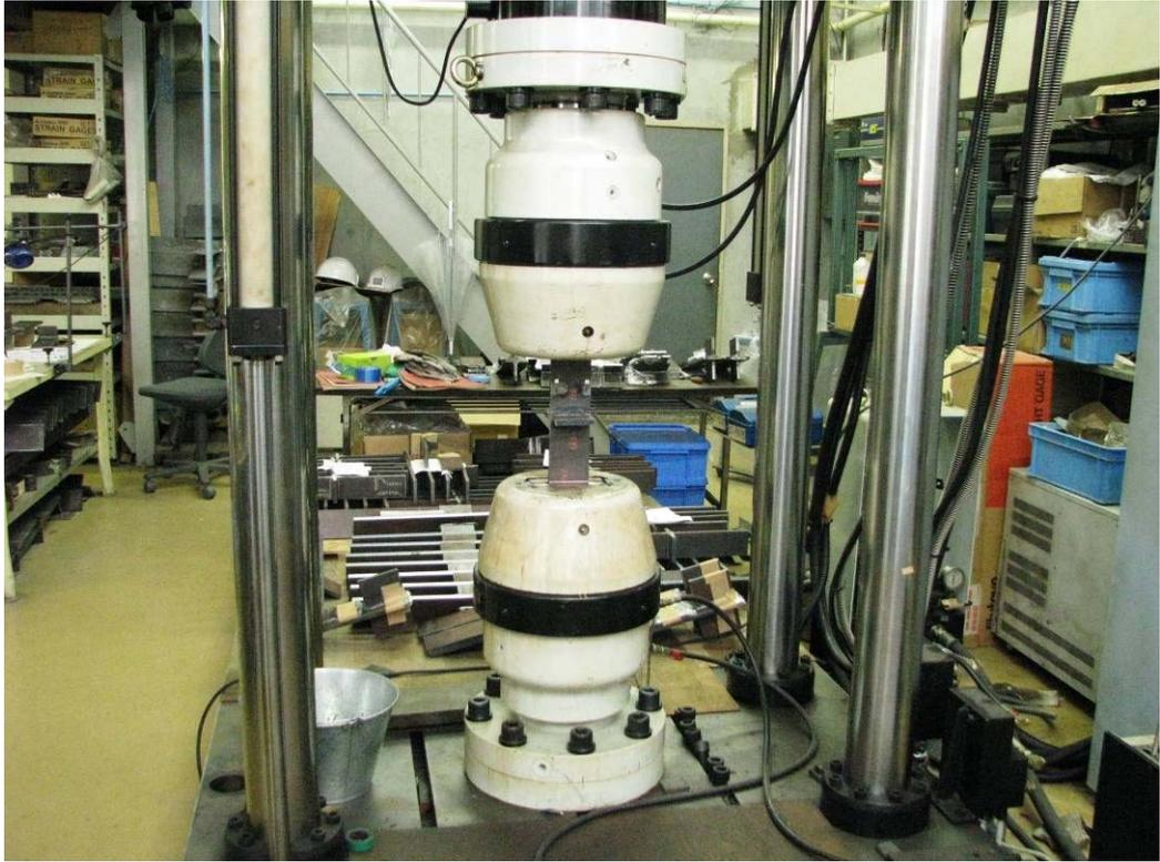
写真 4.4 十字継手の疲労試験
