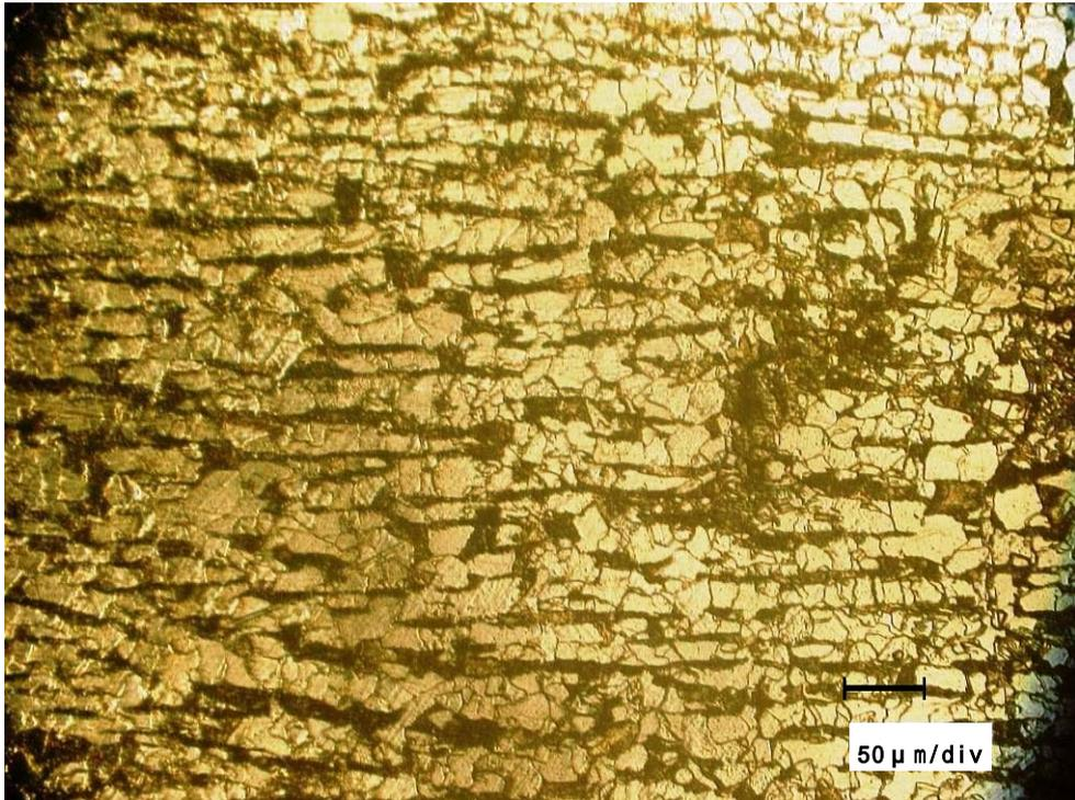
写真 1.5 従来鋼の断面組織（450倍）
