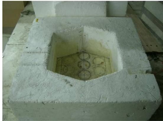
写真 4-6 簡易断熱試験機内部 (タイプ B)
