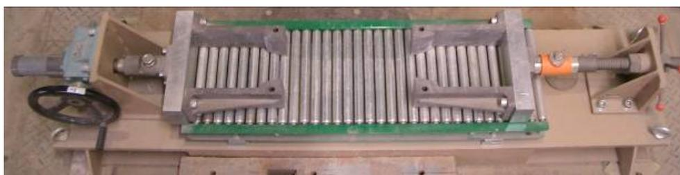
写真 5-1 直接引張試験機
