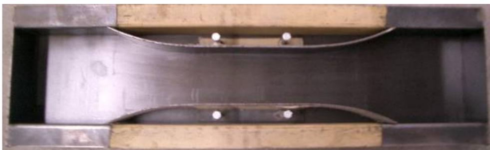
写真 5-2 直接引張強度試験供試体型枠
