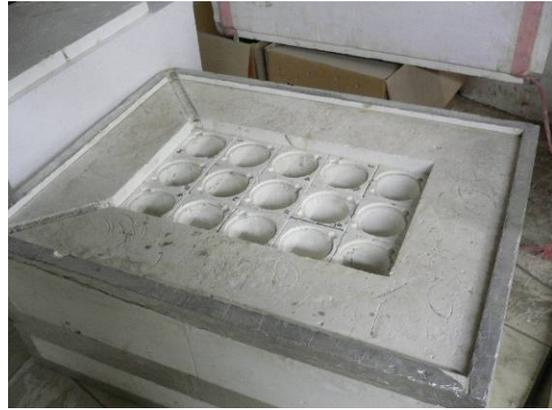
写真 4-2 簡易断熱試験機内部(タイプ A)
