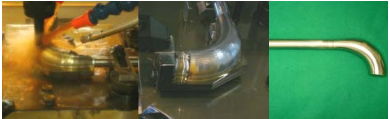
図 2.26 (左)切削の様子 (中)切削途中 (右)完成品
