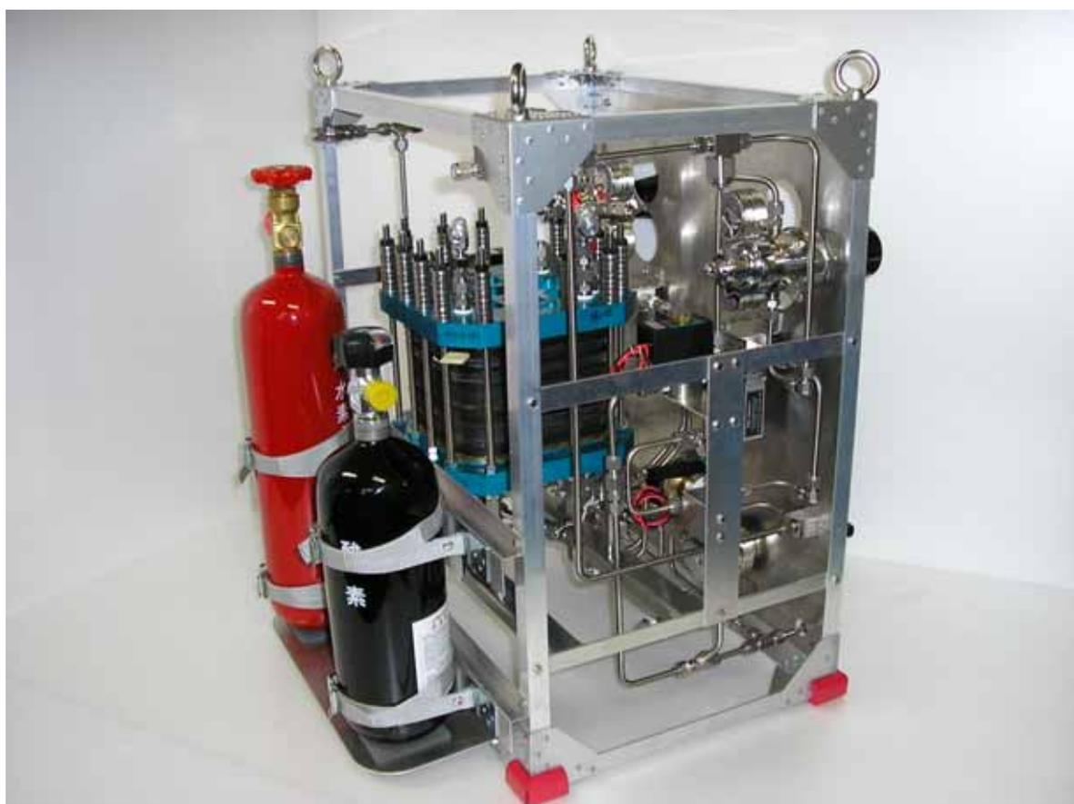
図 57 気球用無加湿型燃料電池
