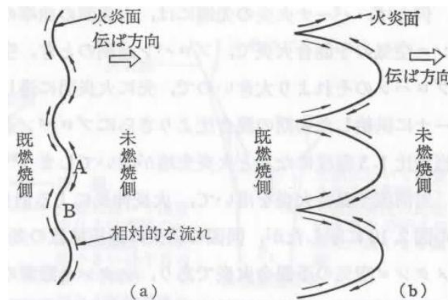
Fig.4-6 火炎面における乱れの増幅機構 18)
