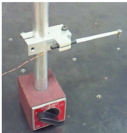
図 4.3 インパルスハンマを固定する治具
