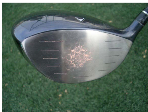
図 3.19 CROSS EIGHT T301 を打ったときに残されたチョーク跡
