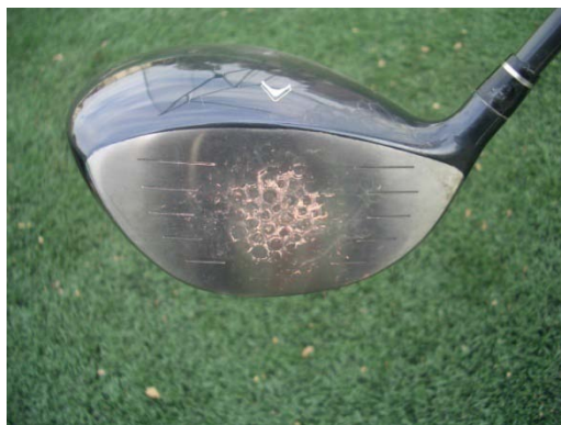
図 3.18 CROSS EIGHT S301 を打ったときに残されたチョーク跡
