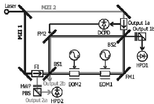
鏡の変位情報の相殺には、前述のDFIを構成する4つのMZIのうちそれぞれ2組のMZIが関与する。例えば、折り返し鏡FM1の変位情報を相殺するには、図に示されるような、FM1を共有する双方向MZIを用いる。重力波信号の影響は残りつつ、かつ光学素子の変位情報は相殺することを示すために、この数100MHz帯で対応する位相変調を印可することが必要となる。ここでは広帯域の電気光学変調素子(EOM: Electro Optic Modulator)を用いて位相変調を印可した。鏡の変位による位相変調を模擬するためには、MZIの片側の光路のBS1とBS2とのちょうど中点に設置したEOM1で位相変調を印可する。一方、重力波信号を模擬するためには光路全体に渡って時間および位置の関数で発展する位相変調を加える必要があるため、重力波信号を厳密に模擬することは現実的には簡単でない。そのため、本実験ではBS1とBS2の間の非対称な位置に置かれたEOM2で位相変調を印可して、重力波相当の信号を生成した。
