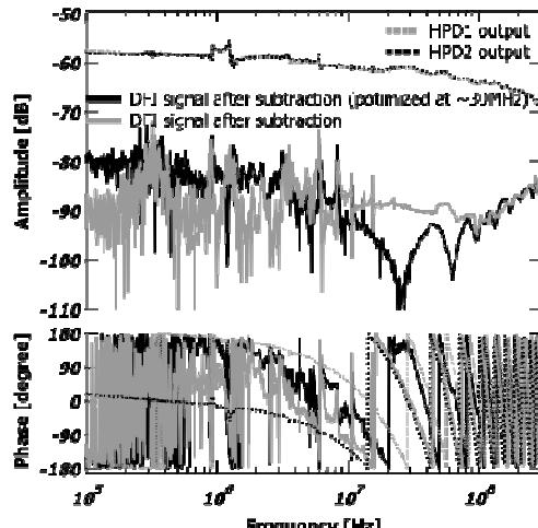
DFIの疑似信号に対する応答特性の測定は、EOM1およびEOM2による疑似変位信号、疑似重力波信号からDFI出力までの伝達関数測定によって行った。変位雑音の相殺の効果を測定した結果を上のグラフに示す。EOM1からHPD1およびHPD2までの伝達関数は、EOM1の位相変調特性およびHPD1とHPD2の応答特性、さらに光学的・電気的な位相遅延を含んでいたため、特徴的な構造を含んだ周波数特性を示す。干渉計の応答としては理想的には平坦な特性が期待される。これら二つの干渉計に現れる変位疑似信号は、光検出器への入射光量および相対的な信号路長(光学的・電気的)を微調整することにより、振幅・位相の両方がよく一致するように合わせ込まれる。この調整の精度によって変位雑音の相殺の精度(同相信号除去比: CMRR)が決まる。図から分かるように、広い周波数帯域で30dB程度のCMRRがみられる一方で、ある特徴的な周波数帯域に於いては50dBのCMRRが観測された。二つの干渉計は極力対称な構成に設定
