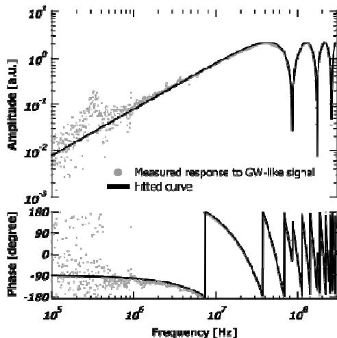
一方、疑似重力波信号に対する DFI の応答特性を上のグラフに示す。HPD1, HPD2 のそれぞれ単体の伝達特性は疑似変位雑音に対するものと類似しているが、引き算した後の DFI 信号は本質的に異なる。これは二つの干渉計の位相応答が異なるためで、ある特定の周波数（最適周波数数 100 MHz）では引き算ではなく足し算の効果となって DFI 信号に現れる。まさにこれが DFI で重力波信号が検出できる所以である。
