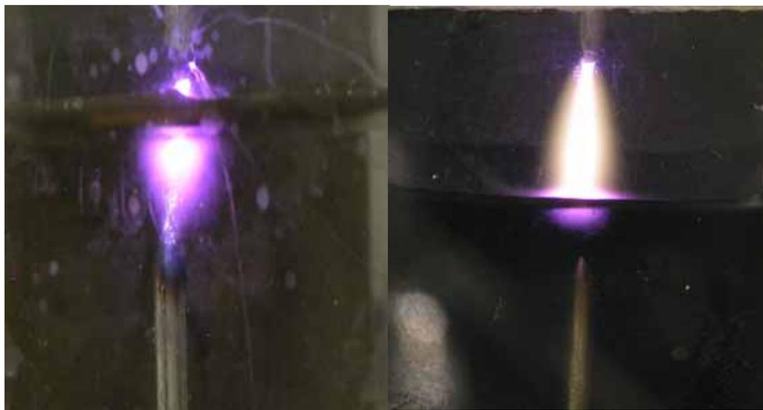
図 2.12 完全な気液放電(右)と不完全な気液放電(左)
