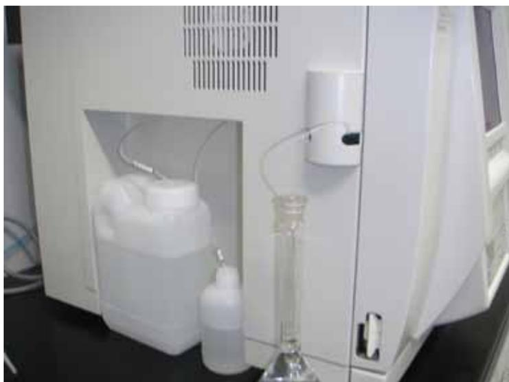
(2)カバーを開け蒸留水補給瓶が白いシールの付箋まで達していることを確認する。また瓶は奥と手前に二つあるので必ず二つとも確認する。
