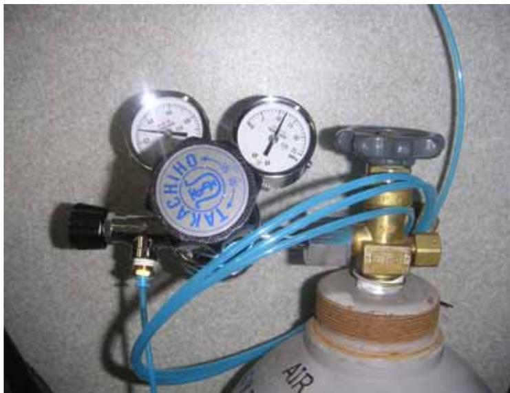
(4)右下にあるスイッチを入れる。同時に白い矢印の流量計のボールが白い付箋まで上昇していることを確認する。上昇しない場合は流量が多すぎて自動で切断されたり少なすぎたりするとボールが浮いてこないのので以上がある場合は減圧弁を確認する。
