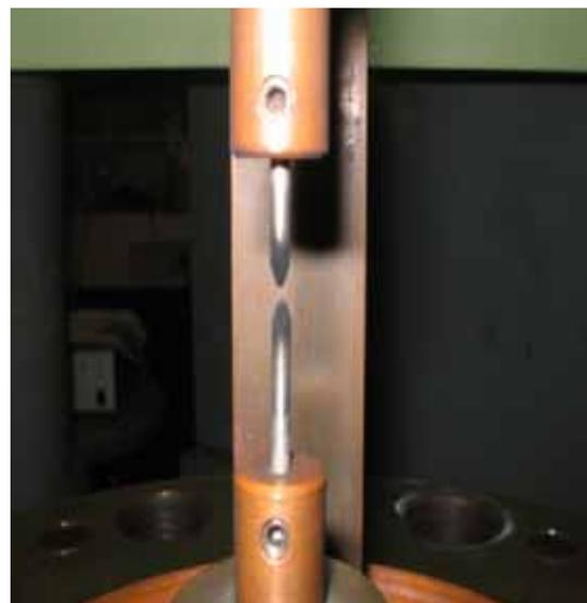
図2.2 超高温・高圧パルス実験装置電極部 (左)装置図,(右)写真
