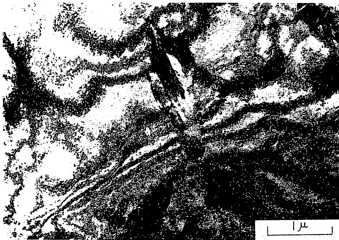
写真3 Fe-0.2C-12Mn-Mo 合金を 500°C で32%加工 (オースフォーム) 後, -70°Cに冷却した場合の変態組織 (透過電子顕微鏡組織)
