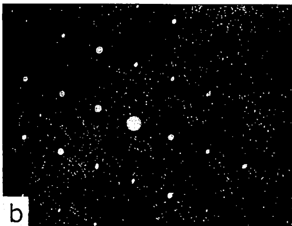
写真1 Fe-0.2C-12Mn-Mo 合金の変態組織 (透過電子顕微鏡組織)
