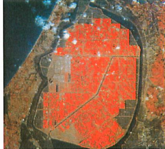
写真11 主成分分析+クラスター分析による推定 稲作地分布（1981年6月16日）
