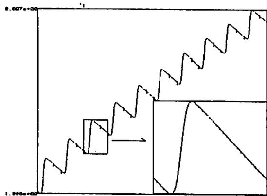
Fig. 2 : 増幅検波器の定常状態応答
