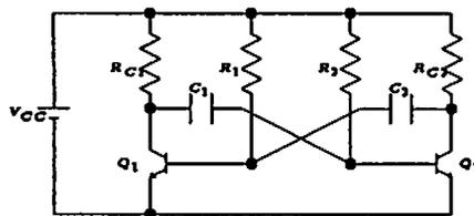
Fig. 5 : マルチバイブレータ
