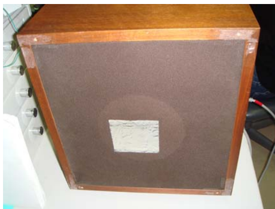
図15 アルミ箔を貼り付けた加振機
