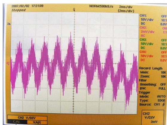
図 44 既存の渦電流式変位・振動センサ 入力振動 500[Hz] (2ms/div-2mV/div)
