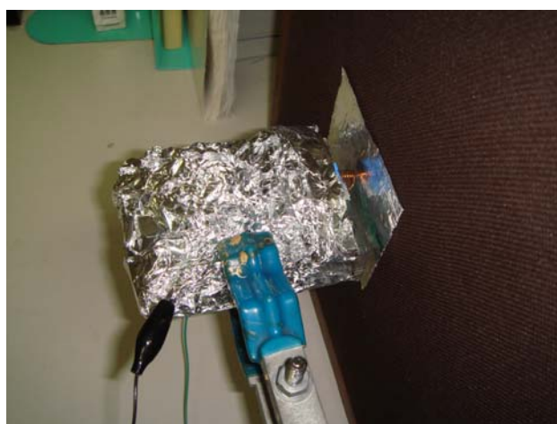
図 18 シールドを施した FM ワイヤレス渦電流式変位・振動センサ
