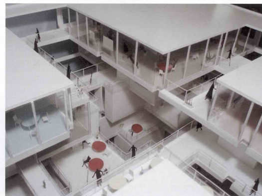
吹き抜けを生かすことのできる屋根。7Fのスラブから垂直に持ち上げることによって7Fの大きな空間が独立する。
