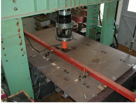
【写真 3.4】正曲げ载荷試験
