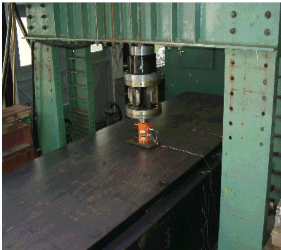
【写真 3.2】 2 主桁実験の載荷状態
