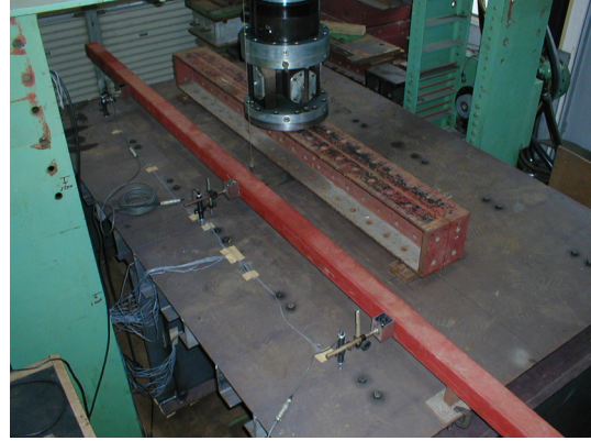
【写真 3.5】負曲げ载荷試験
