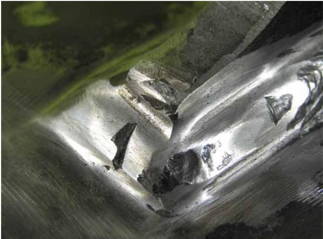
(d) -FG 試験体溶接部
