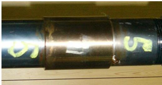
図 1.16 鉄系形状記憶合金管継手
