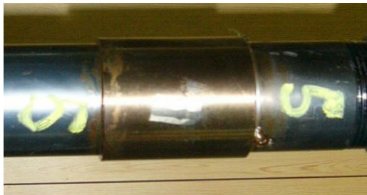
図 1.16 鉄系形状記憶合金管継手
