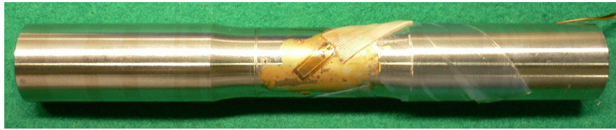
図 2.8 ひずみゲージ貼付後のねじり試験片
