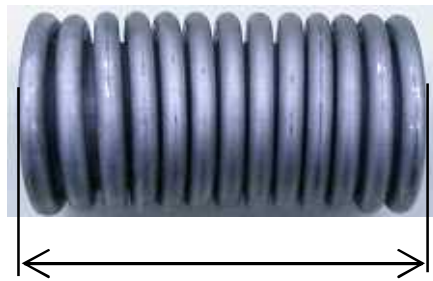
図 22 圧縮試験終了後のベローズ管
