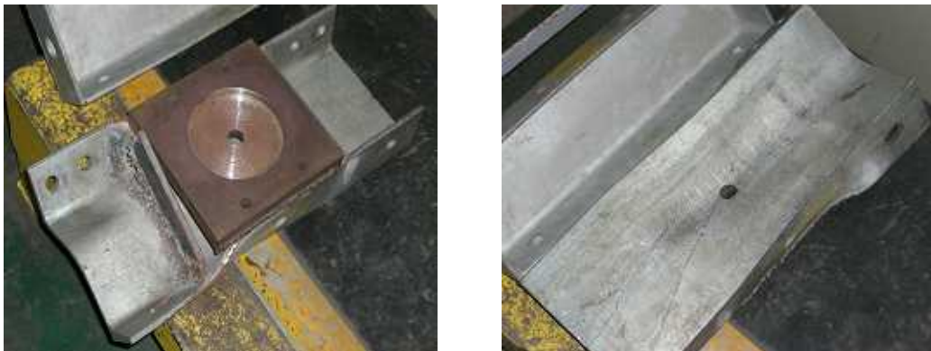
図 53 陥没した治具
