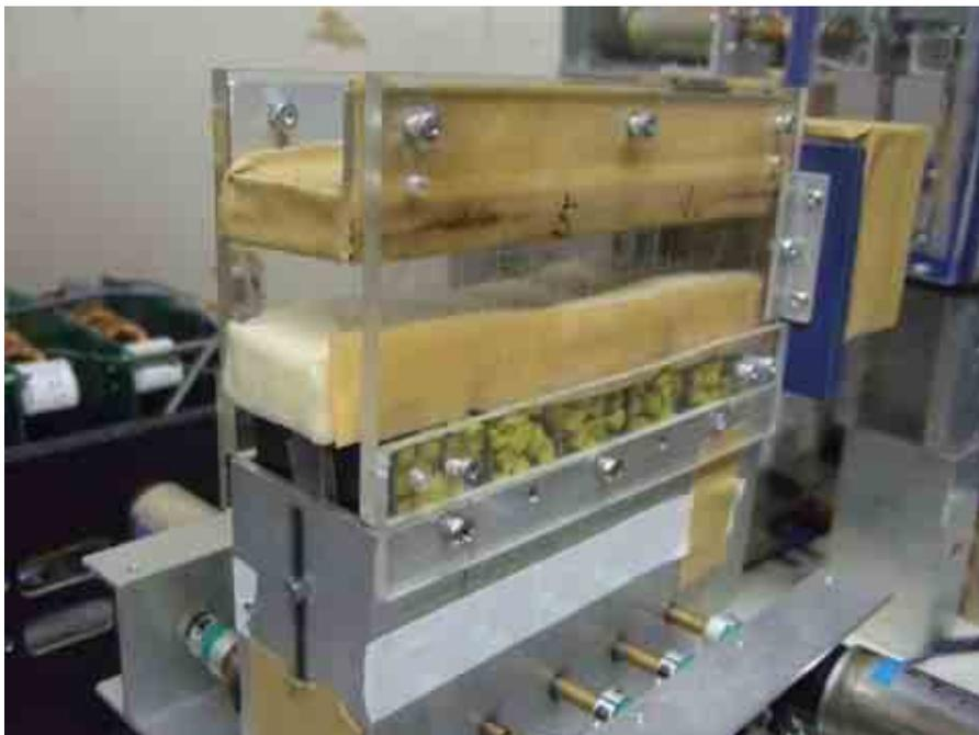
Fig.7.1 飴ゴムによる気密処理をおこなった Singer Robot
