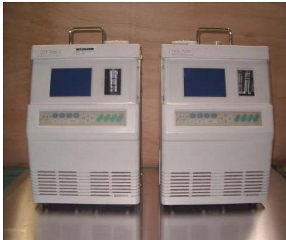
Fig. 5 赤外線式ガス濃度測定装置、燃焼排ガス NO x - O 2 測定装置
