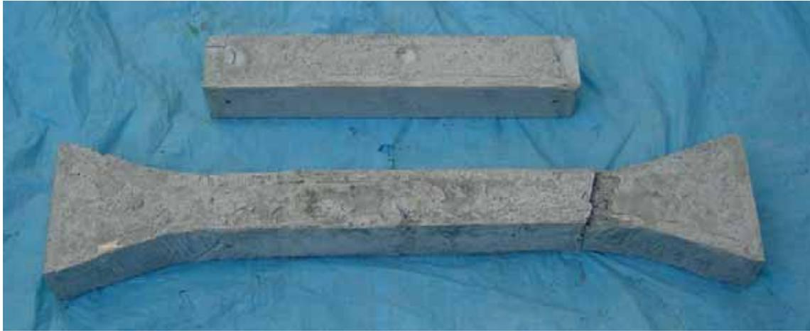
写真 3.7 脱型後の各供試体
