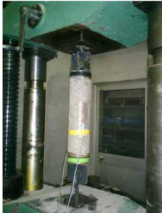
写真 4.1 円柱型直接引張強度試験概要
