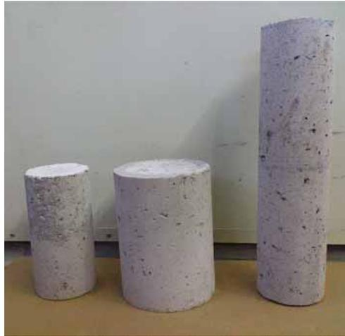
写真 4.2 強度試験用供試体
