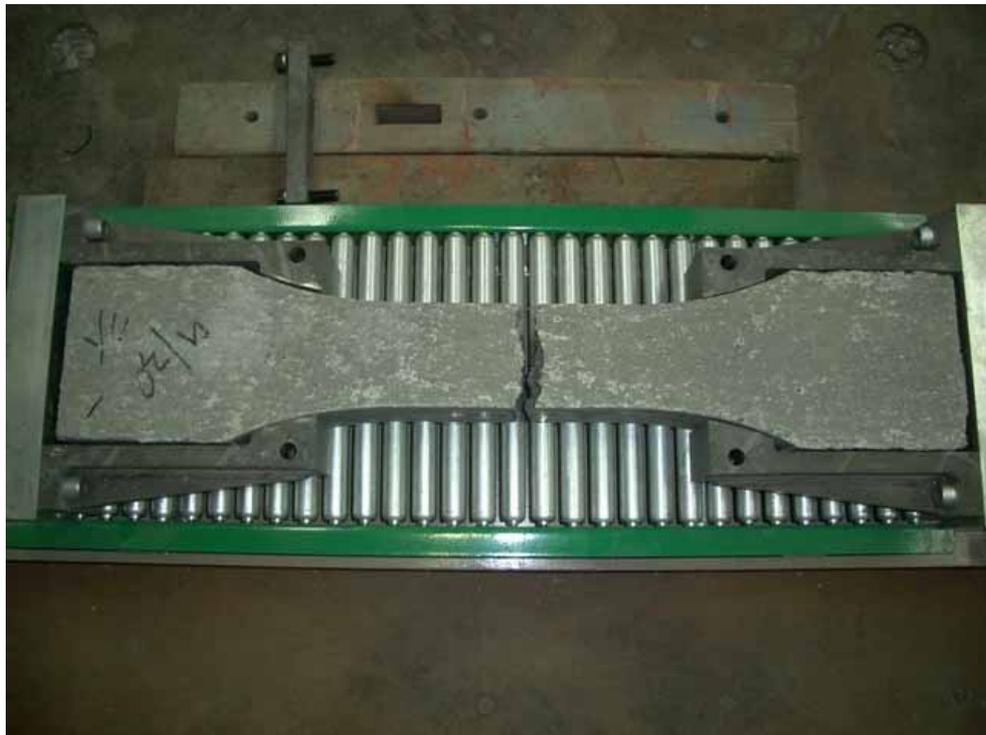
図 7.5 角柱型直接引張供試体破断位置
