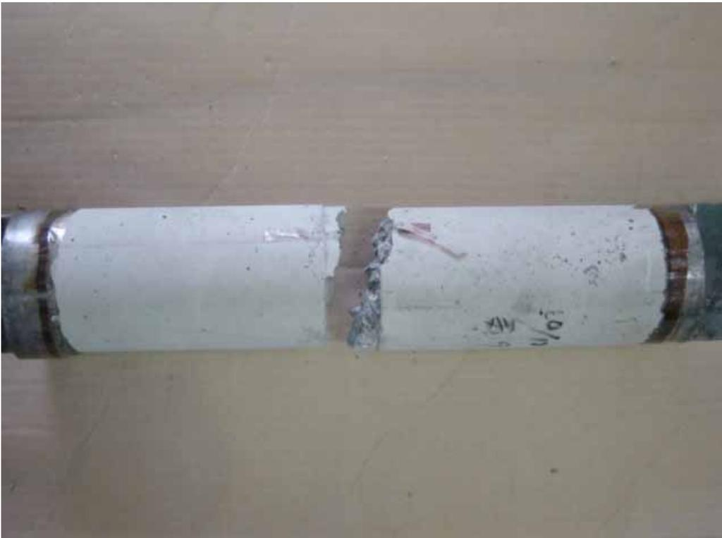
图 7.3 圆柱型直接引張供試体破断位置
