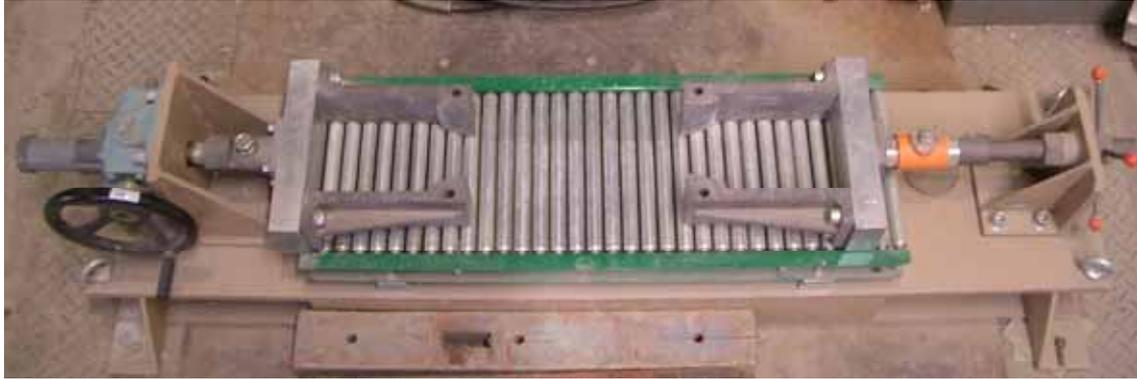
写真 5.1 角柱型直接引張強度試験機
