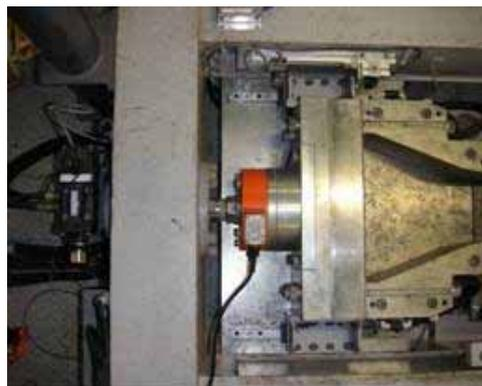
写真 3.3 拘束試験装置概要(ロードセル・アクチュエータ)
