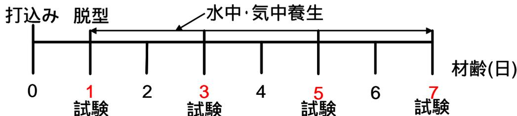
図 5.3 打込み・試験フロー図
