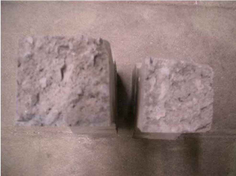
図 7.4 角柱型直接引張供試体破断面
