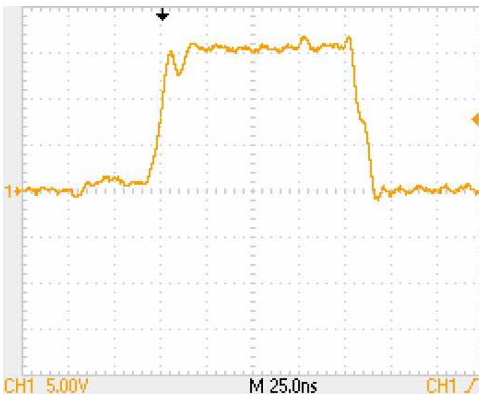
図 3 7 変更後のドライバ回路による出力波形（印加電圧 1 5 V）
