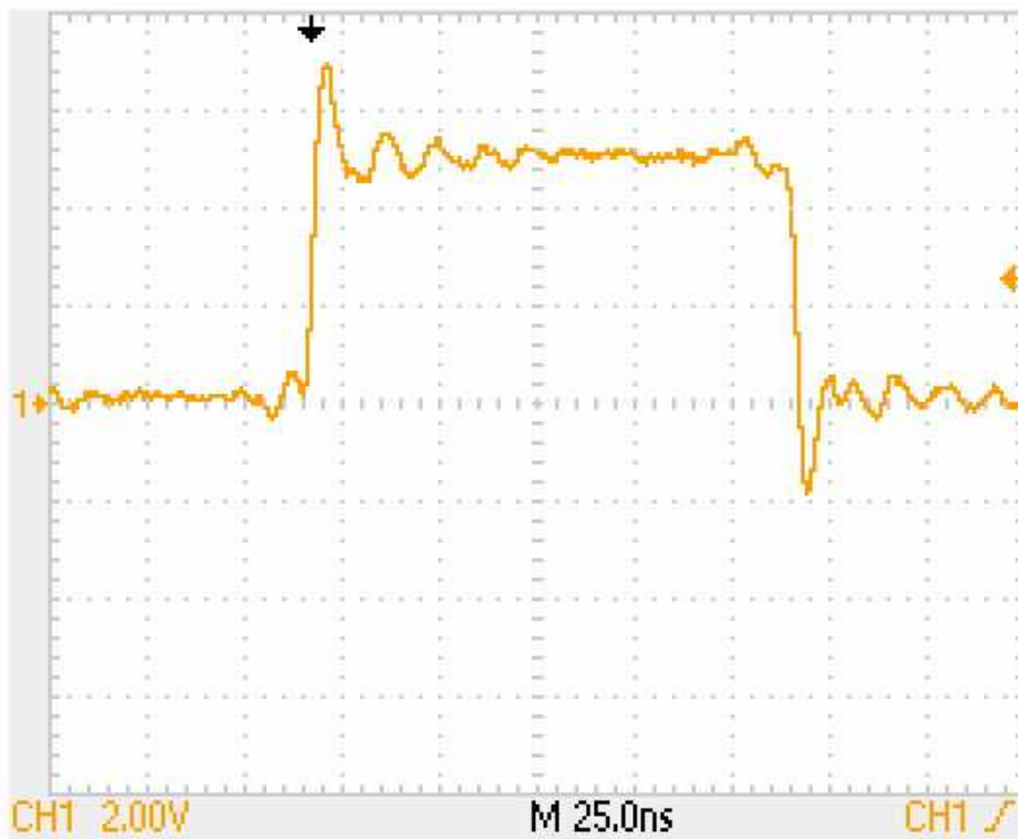
図 3 5 従来のドライバ回路による出力波形（印加電圧 5 V）
