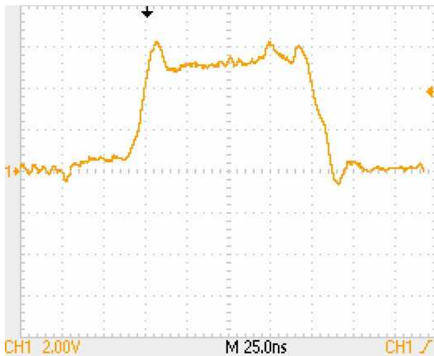
図 3 6 変更後のドライバ回路による出力波形（印加電圧 5 V）
