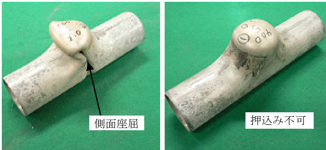
図 5-12 押込み圧力における成形状況
