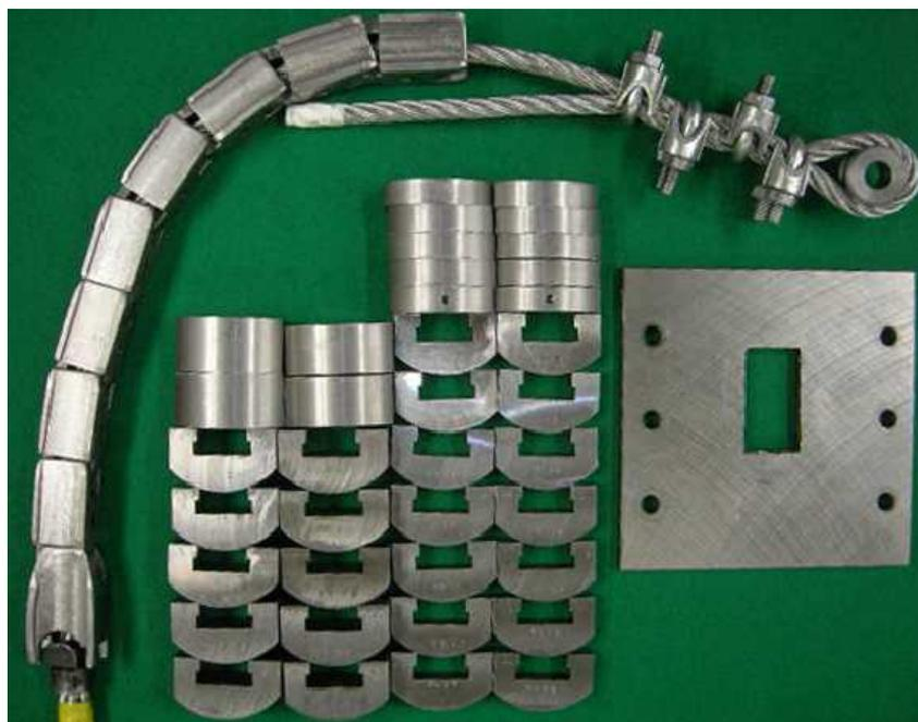
図 17 牽引拡げ加工に用いた各部品
