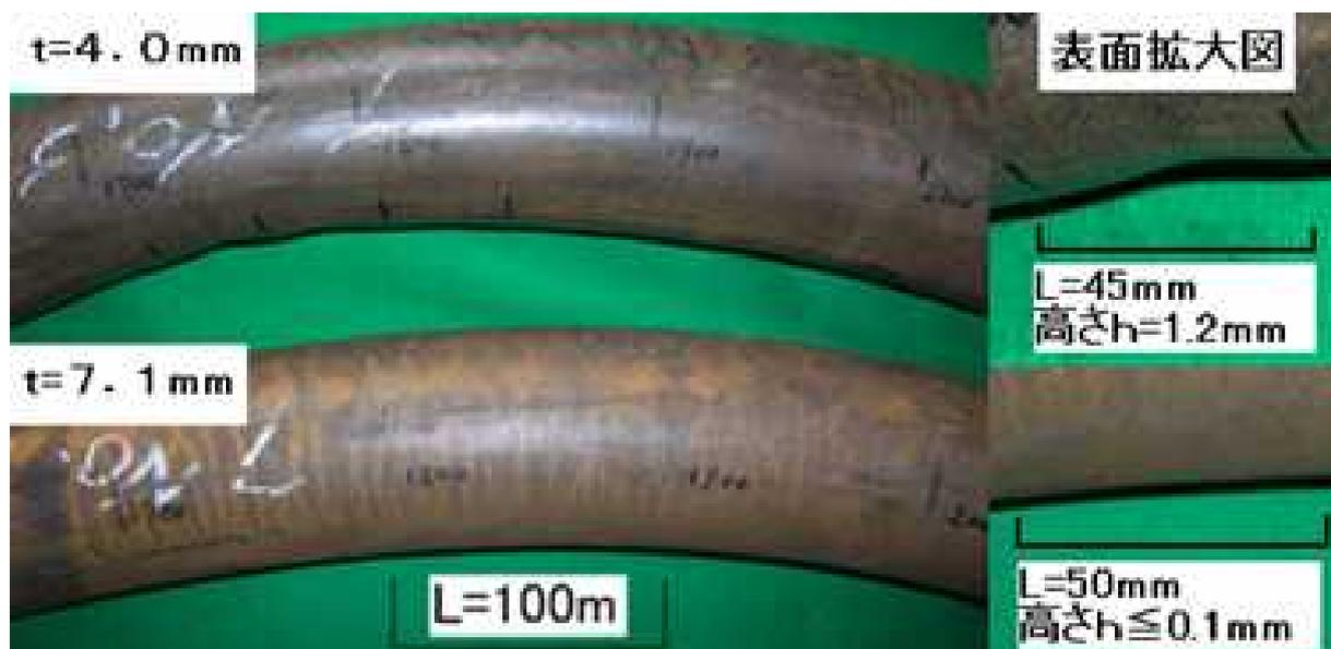
図 28 供試管肉厚と表面のしわ
