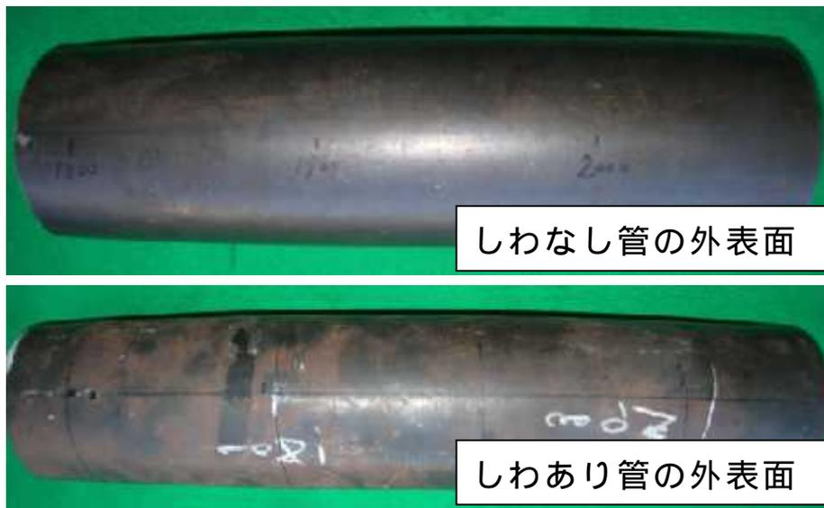
図 32 拡管後、管の曲げ外側表面状況
