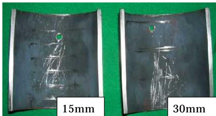
図 33 15mm と 30mm の拡管ダイスによる管内部のダイス圧痕
