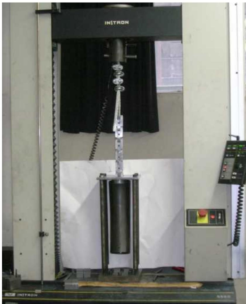
図 18 牽引拡げ加工実験の状況
