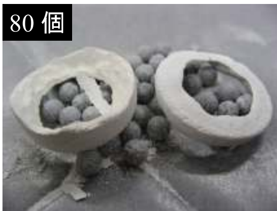
図 5-2 熱処理温度 1600 °C、保持時間 1 h、ロータリーキルン炉の回転数 1 rpm、 Si 3 N 4 ボールの個数 16, 40, 80 個の条件で合成した粉末の写真
