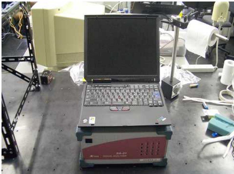
写真4 FFTアナライザ&ノートPC
