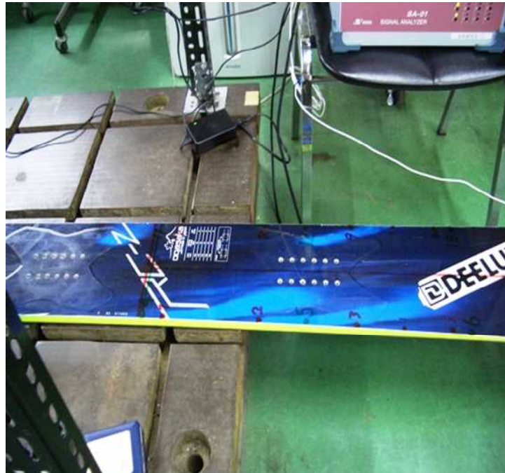
写真 9 後方部のピンディング固定部分
