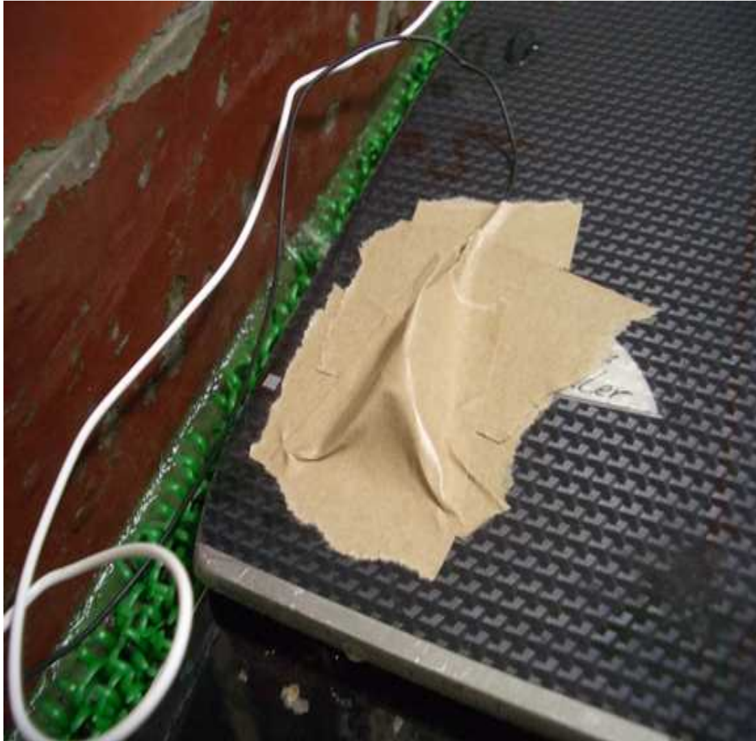
写真 1 6 加速度ピックアップ取り付け部分
