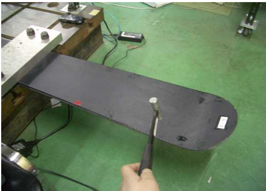
写真 25 前方部分の固定振動試験
