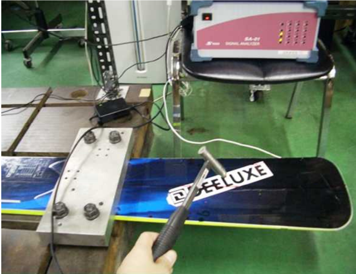
写真 8 ビンディング部分を固定した状態
