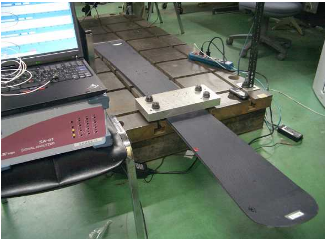
写真 24 前方部分の固定振動試験
