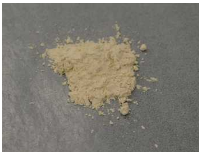
図 3-5 Ca 型フォージャサイトのヨウ素吸着直後と一週間後の様子
