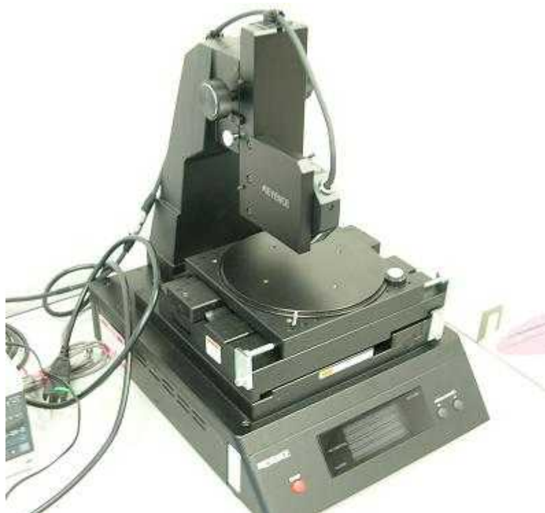
Fig.4.3.1-1 3次元レーザー形状測定装置
