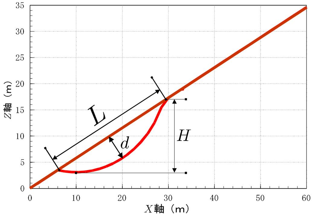
図 5.2.1 すべり面側面図 ( $X-Z$ 平面)
