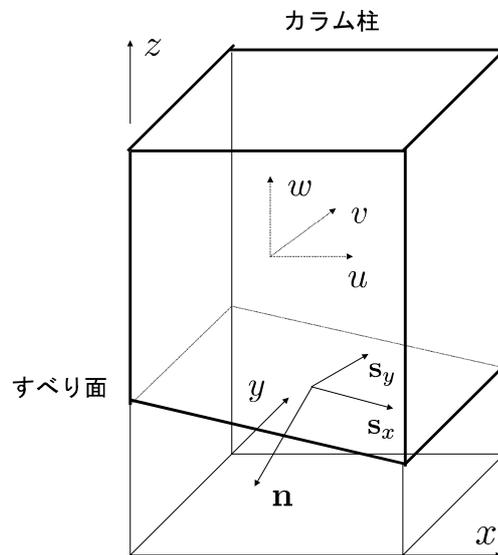
図 4.2.6 すべり面の法線ベクトル
