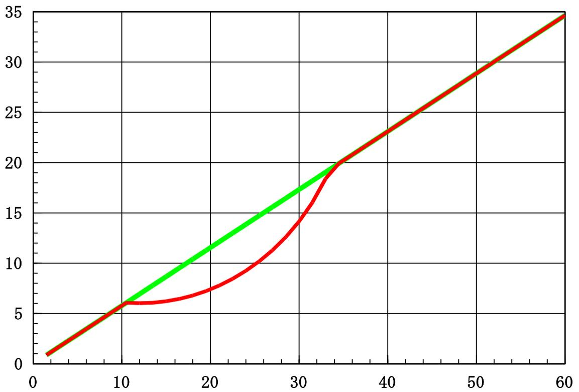
図 12 すべり面側面図 (d=3.94m)
