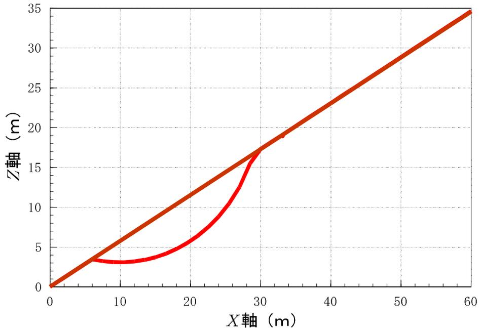
図 4.4.2 X-Z平面上でのすべり面
