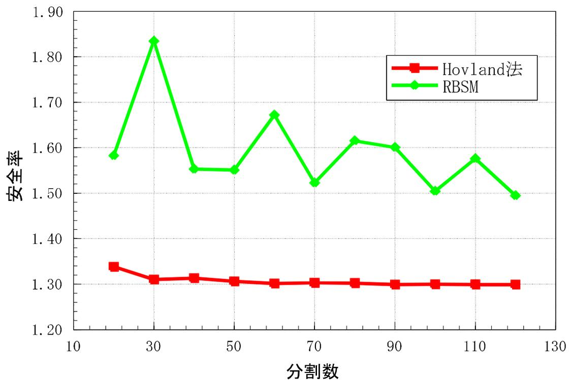
図 4.4.6 球状すべり面の分割数と安全率の関係（Hovland 法と RBSM の比較）
