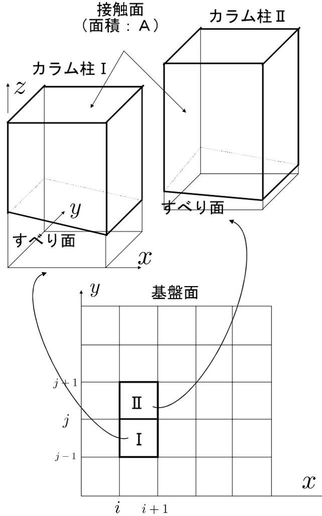
図 4.2.5 カラム柱の接触面 (y方向)
