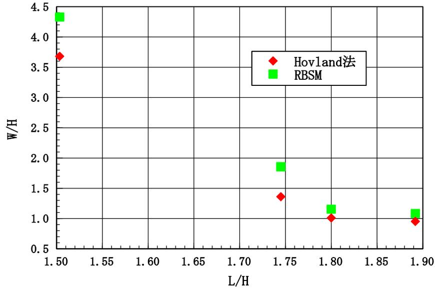
図 5.3.7  $L/H$  推移による収束ポイントの変化
