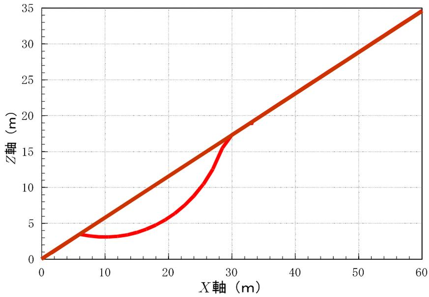
図 4.4.8 X-Z平面すべり面（側面図）
