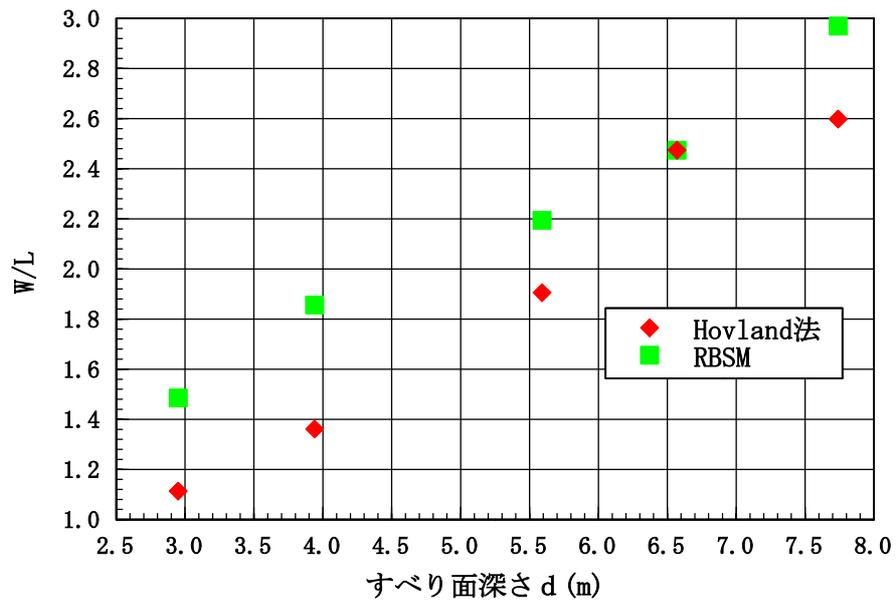
図 5.4.9 すべり面深さ  $d$  推移による収束ポイントの変化
