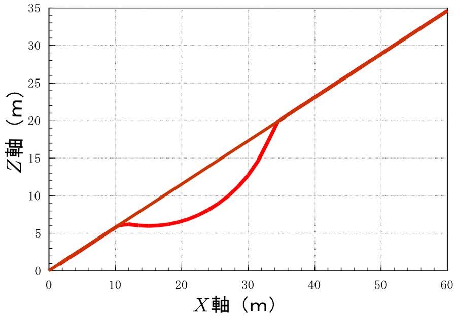
図 3.3.6 X-Z平面上でのすべり面
