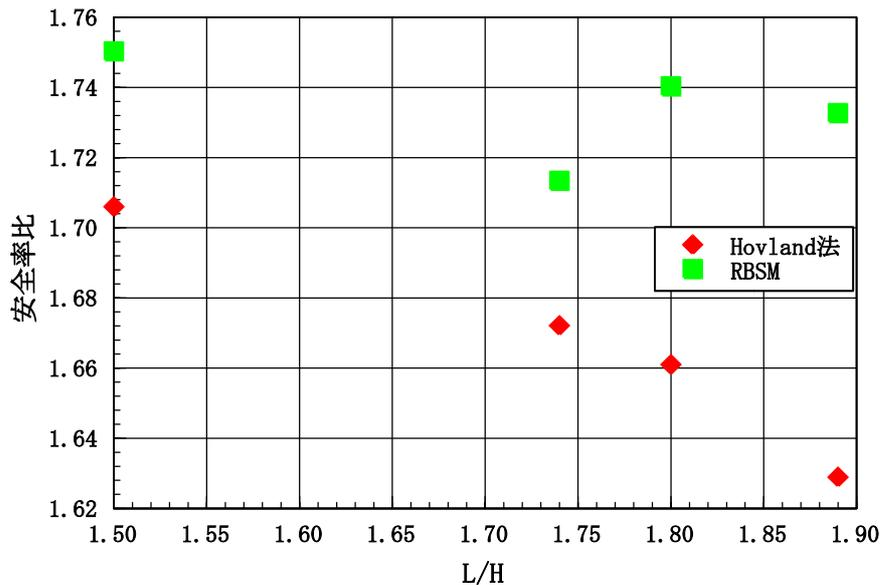
図 5.3.8  $L/H$  推移による安全率比変化 (収束時)
