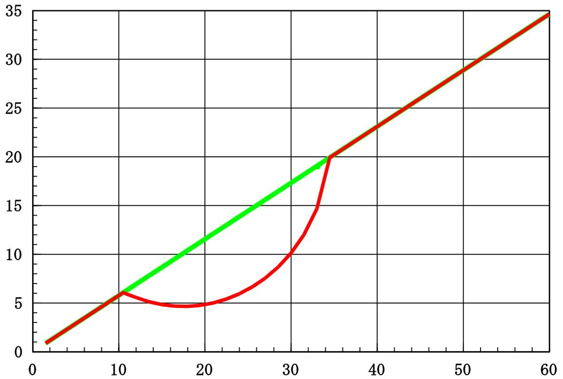
図 16 すべり面側面図 (d=6.57m)
