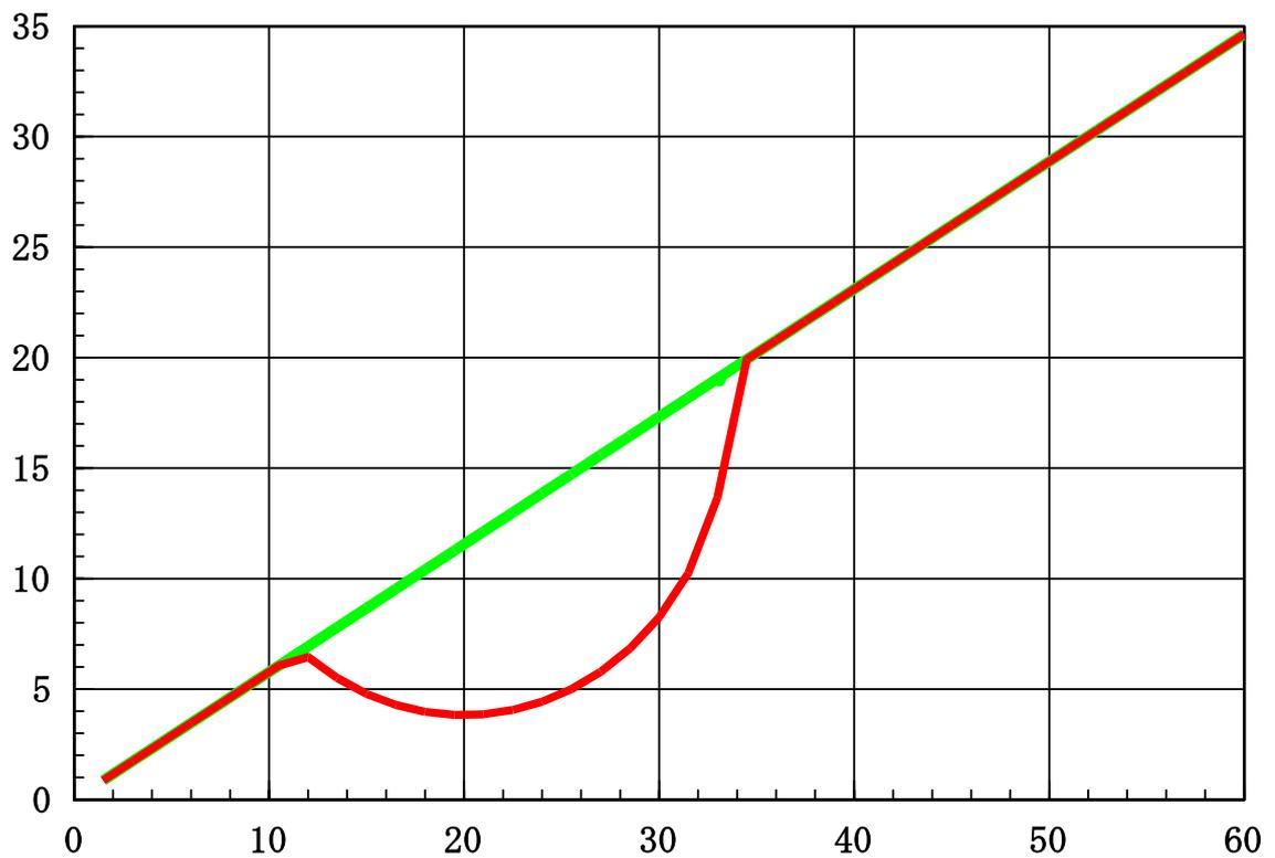
図 18 すべり面側面図 (d=7.74m)
