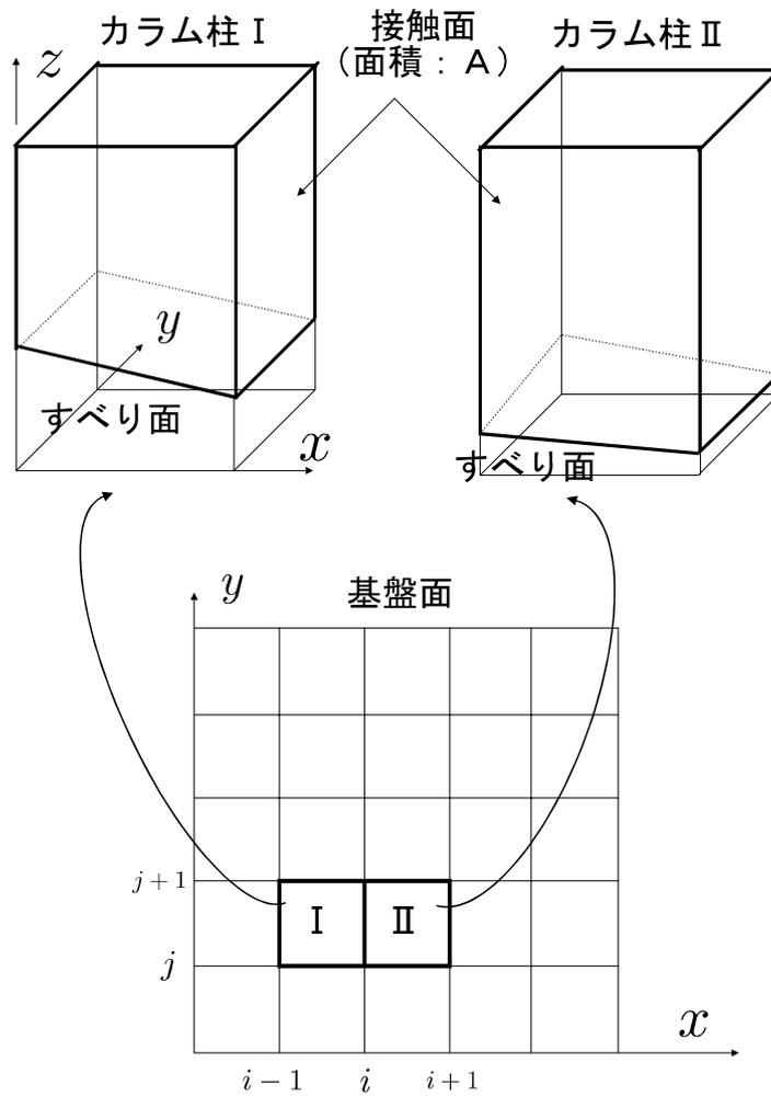
図 4.2.4 カラム柱間の接触面 ( $x$ 方向)
