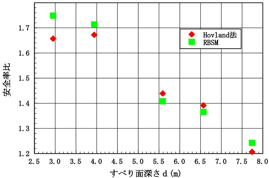
図 5.4.10 すべり面深さ  $d$  推移による安全率比（収束時）
