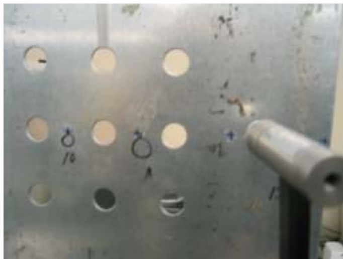
Fig. 4.1.1 インパルス・ハンマによる加振
