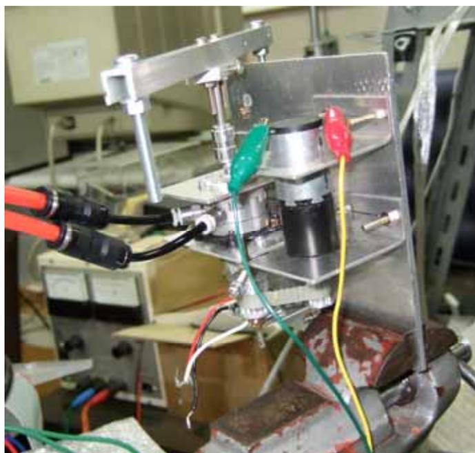
Fig3-7 回転直線駆動形評価用試作機
