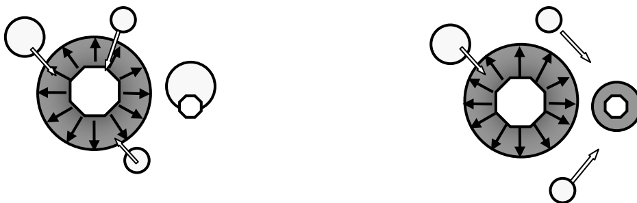
図 2.5 浸透圧による水分移動 (STEP 2: 場の温度が -10 に低下した場合)
