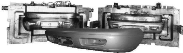
写真10 Mutual 社によるインド国内初生産のバンパー用金型と成形品 (1996年 タタ自動車納入)
