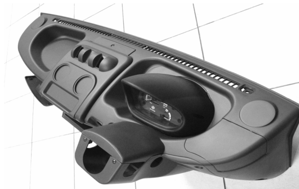
写真11 Mutual 社が金型製作・成形した自動車用ダッシュボード
