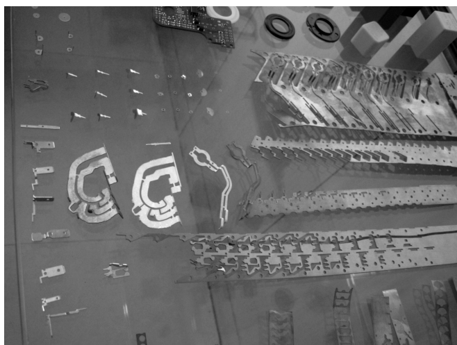
写真16 同社製作の精密金属プレス部品
