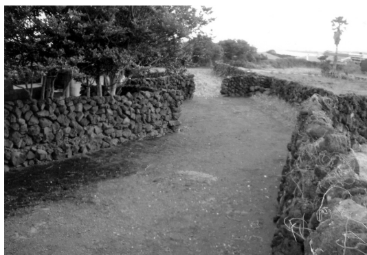
写真 6 新山里集落の周辺における防風石垣。 道路の曲がりにそって曲率をつけて 積んだ石垣。
